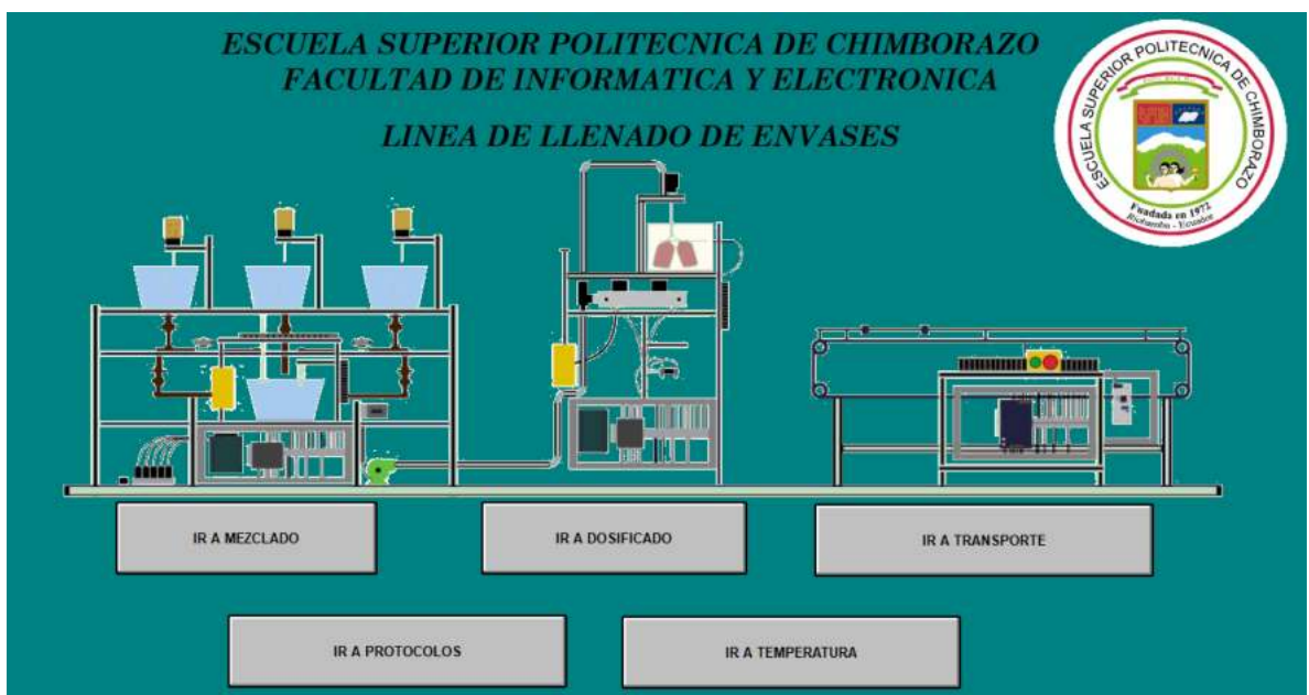
Figura 65-2: Menú de inicio de sistema SCADA
