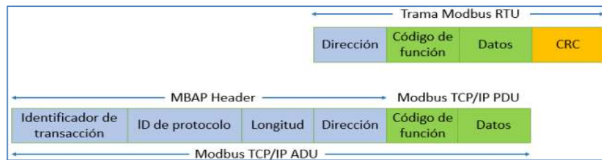
Figura 21-1: Formato de trama Modbus TCP
