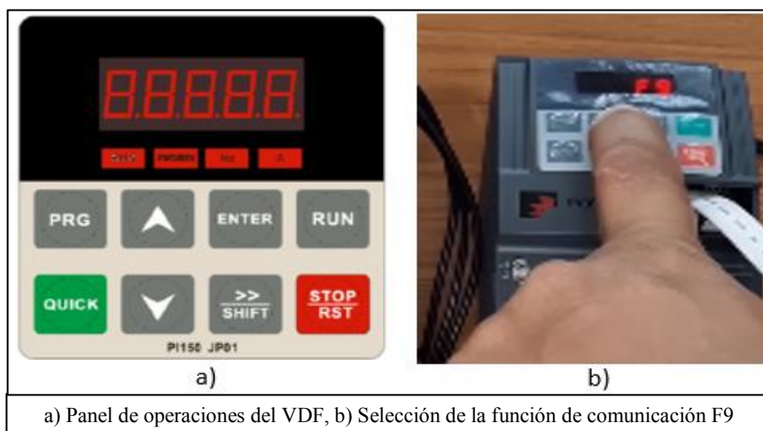
Figura 38-2: Configuración de parámetros de comunicación
