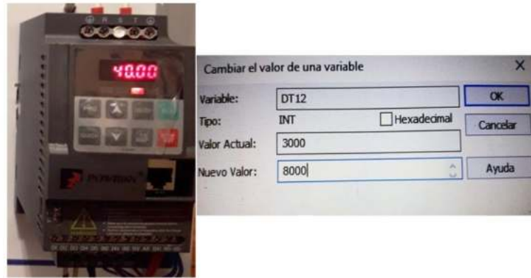
Figura 11-3: Cambio de frecuencia en VDF
