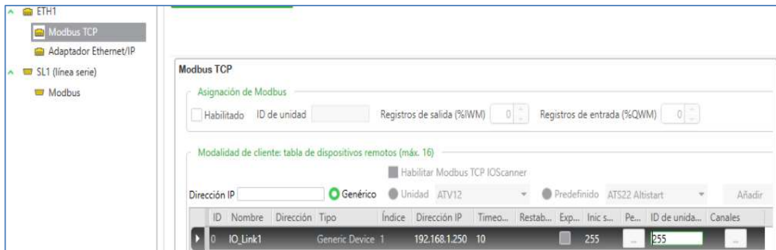
Figura 24-2: Configuración de modo cliente/servidor para Modbus TCP
