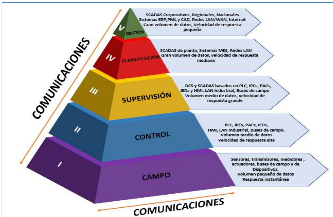
Figura 1-1: Pirámide de automatización industrial
