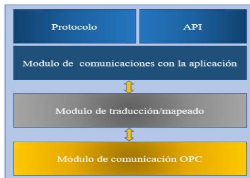
Figura 28-1: Estructura de un Cliente OPC
