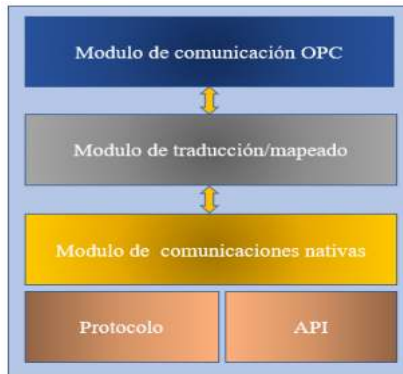
Figura 27-1: Estructura conceptual de un servidor OPC
