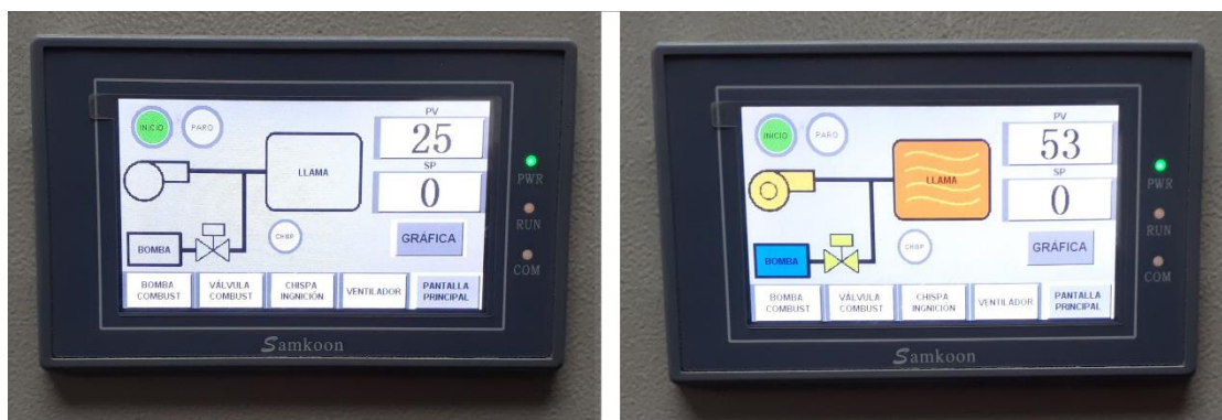
Figura 3 -3. Pantalla del modo manual antes y después de activar los actuadores. Realizado por: Sangucho F.y Saavedra E., 2020.
