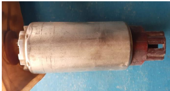
Figura 22 - 2. Bomba de combustible. Realizado por: Sangucho F. Saavedra E. 2020.
