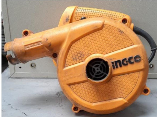
Figura 4 - 2. Ventilador centrífugo. Realizado por: Sangucho F. y Saavedra E., 2020.
