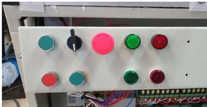
**Figura 48-3:** Instalación de Botones, Indicadores y Selector
