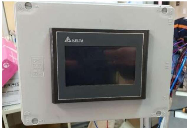
**Figura 49-3:** Implementación del HMI Delta
