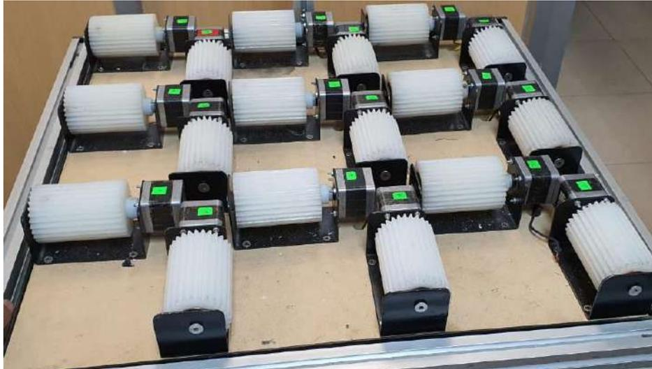
**Figura 35-3:** Motores con Rodamientos Dentados Implementados para la Pista
