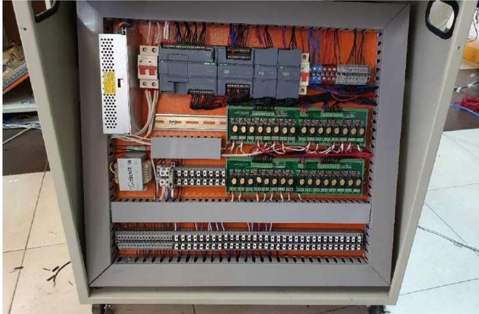
**Figura 47-3:** Colocación del Tablero dentro de la Base Metálica
