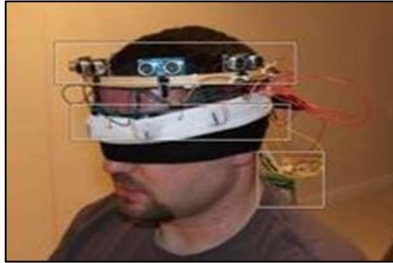
**Figura 3-1:** Usuario utilizando dispositivo HALO
