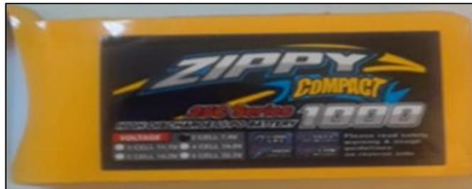
**Figura 8-2:** Batería Lipo 7,4 V
