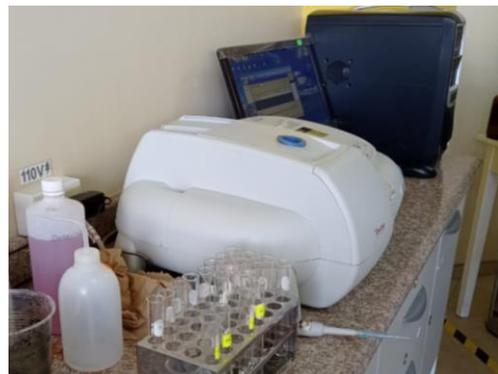
**Nitrógeno orgánico y fósforo por espectrofotometría UV visible**
