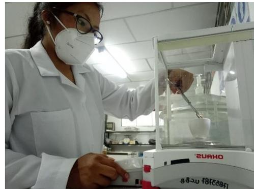
**Peso de crisol (tarado) vacío y muestra**
