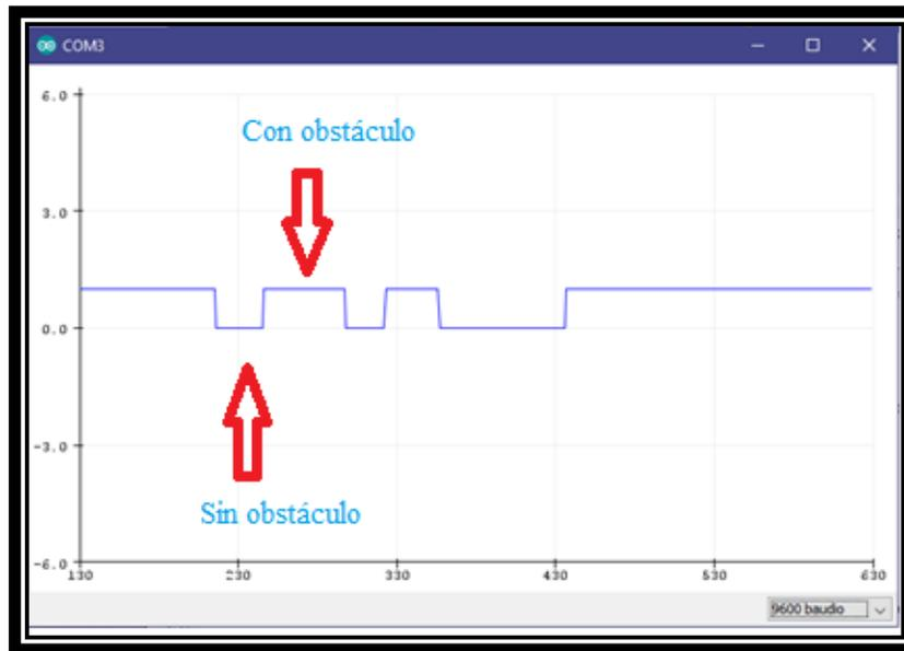
**Figura 27-3:** Validación de la señal del sensor infrarrojo IR FC-5.
