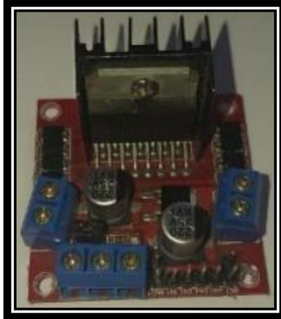
**Figura 12-3:** Módulo Puente H L298N para control de motores.
