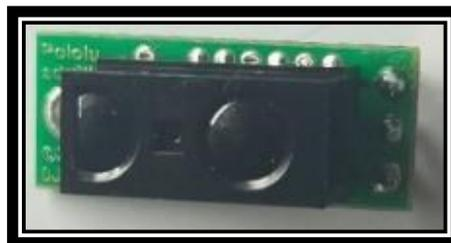
**Figura 6-3:** Sensor infrarrojo de distancia Sharp GP2Y0D810Z0F.
