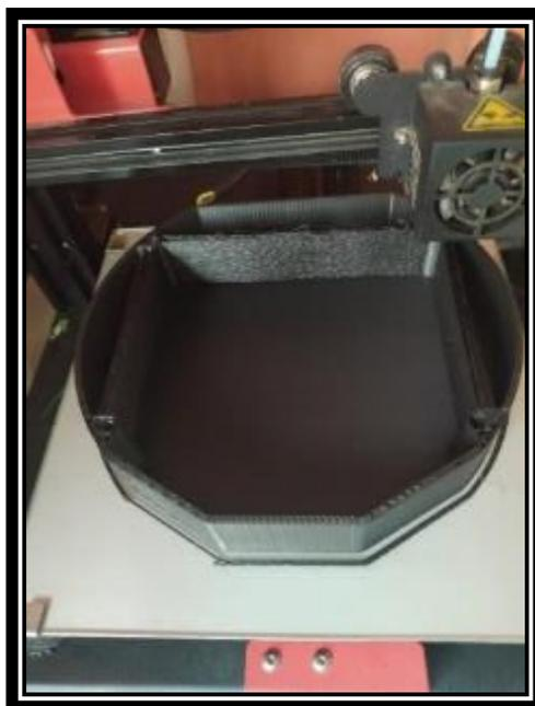
**Figura 22-3:** Impresión en 3D de la caja del prototipo RDUV-C
