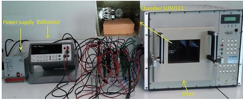
**Figura 2 - 2:** Configuración del experimento durante una prueba HRTB.
