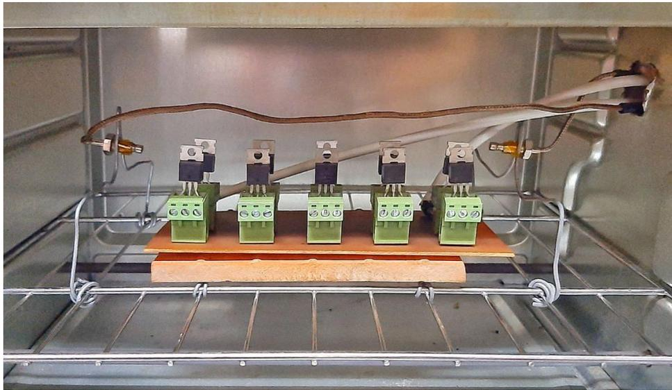
**Figura 2 - 4.** Placa para pruebas HTRB
