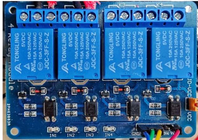
**Figura 5 - 3.** Módulo de relés de cuatro canales.
