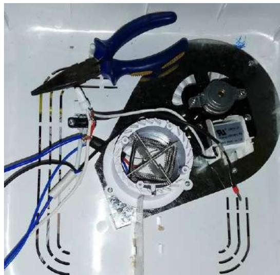
**Figura 4-2:** Sistema Térmico del deshidratador EZ-Store.
