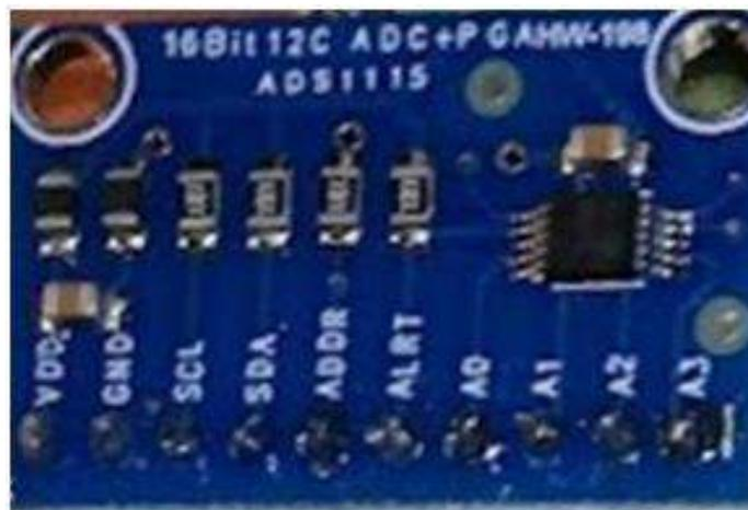
**Figura 6-2:** Convertidor A/D ADS1115.
