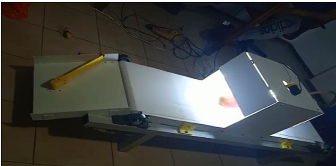
**Figura 42-3:** Estructura consolidada del prototipo de clasificación de mangos
