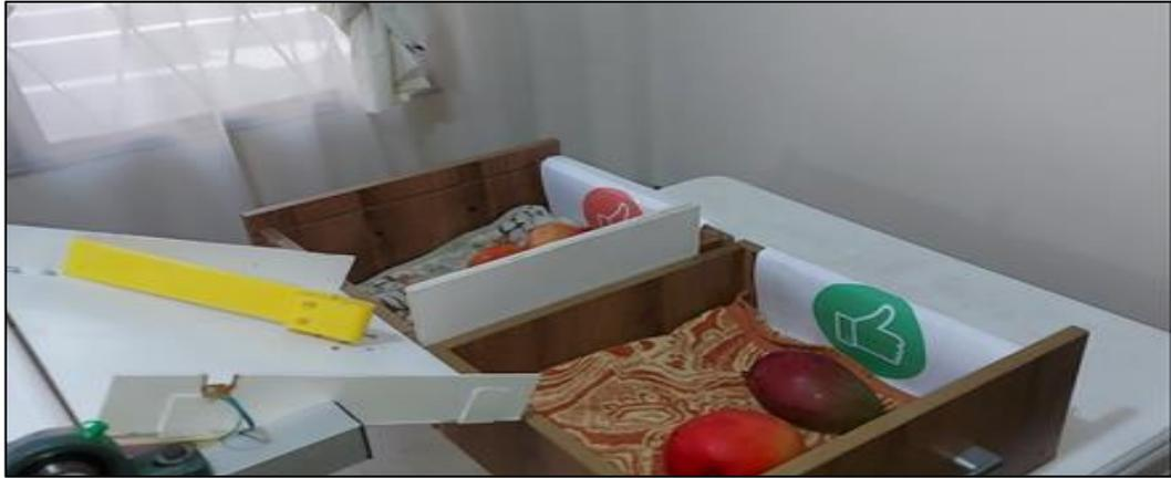
**Figura 40-3:** Imagen del activador con sus respectivas salidas de aceptación y rechazo
