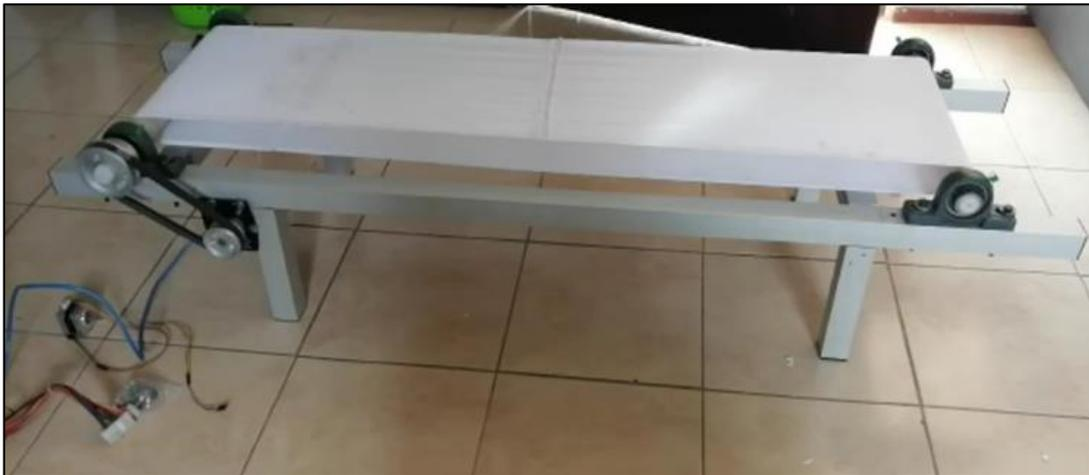
**Figura 43-3:** Estructura base del prototipo de clasificación de mangos
