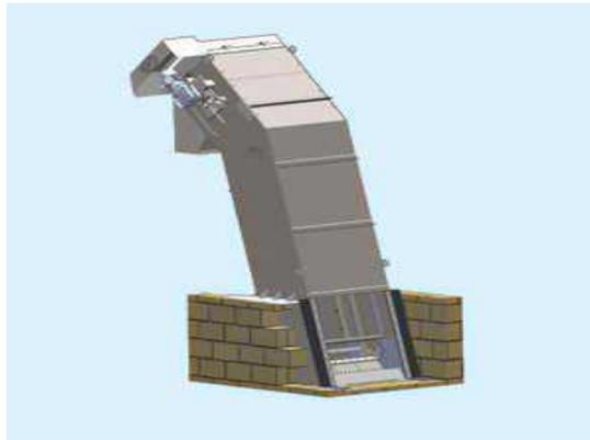
**Ilustración 2-2:** Sistema de rejillas de sistema mecánico o automático
