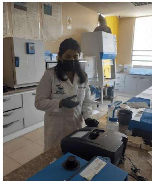
Determinación de Cromo Hexavalente, sulfatos y nitratos por método de HACH.
