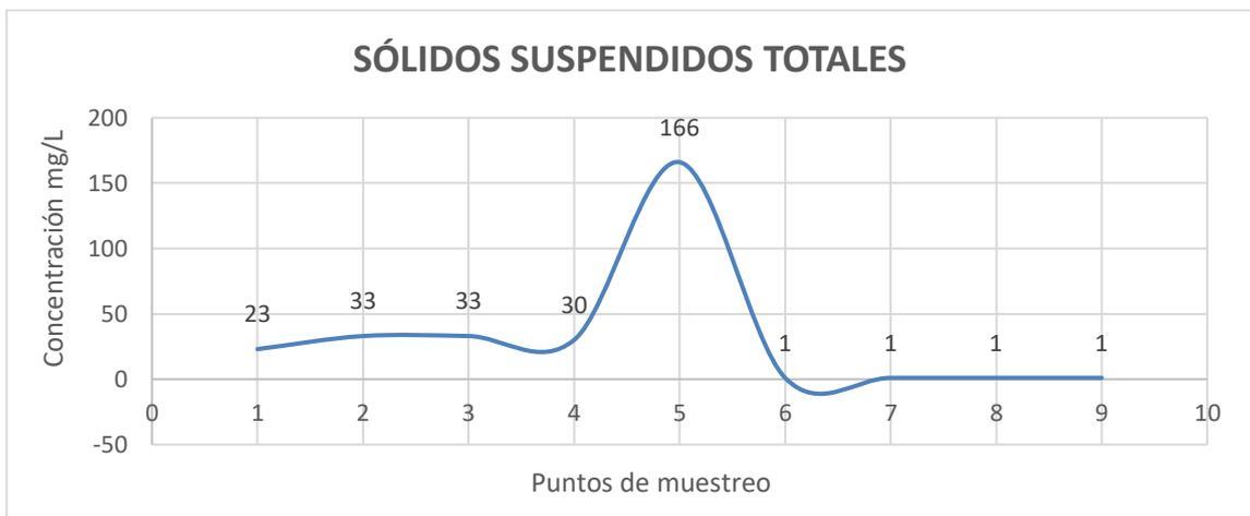
**Ilustración 4-7.** Concentración de los datos de sólidos suspendidos totales en los 9 puntos de muestreo
