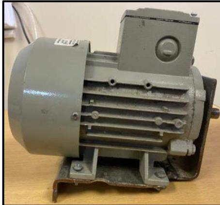
**Figura 20-2.** Motor trifásico Siemens
