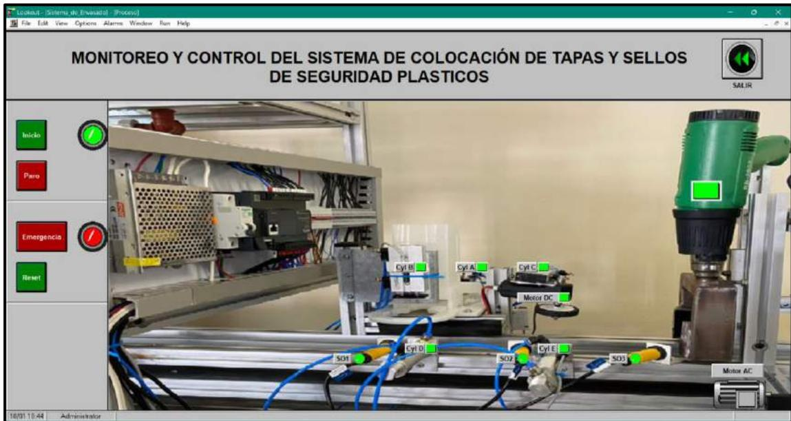
**Figura 42-2.** Panel de control y monitoreo del sistema.
