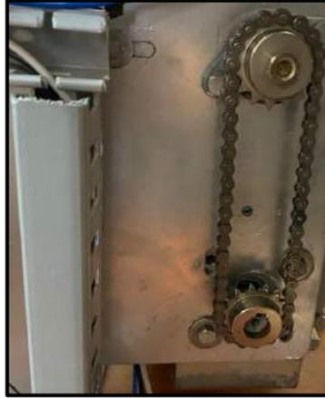
**Figura 36-2.** Conexión mecánica de la banda transportadora.
