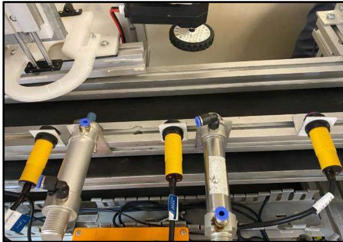
**Figura 29-2.** Sensores y cilindros integrados en el sistema.
