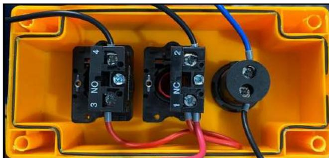
**Figura 35-2.** Conexión de la botonera.
