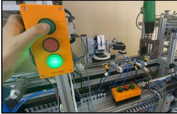
**Figura 2-3.** Botonera para pruebas de PLC
