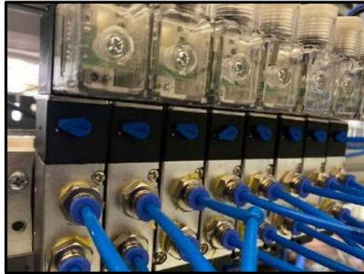
**Figura 6-3.** Prueba de funcionamiento de electroválvulas
