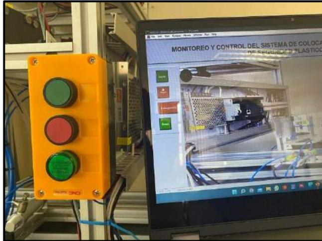
**Figura 10-3.** Prueba de control de apagado del sistema mediante HMI.
