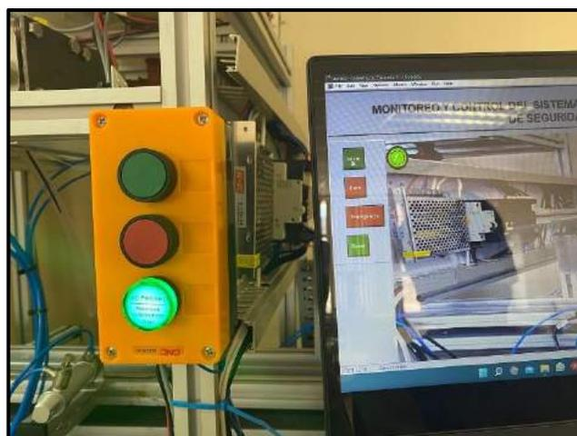
**Figura 9-3.** Prueba de control de encendido del sistema mediante HMI.
