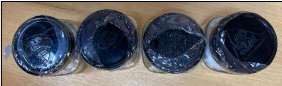
**Figura 14-3.** Resultados del sellado con 8 segundos, vista superior.
