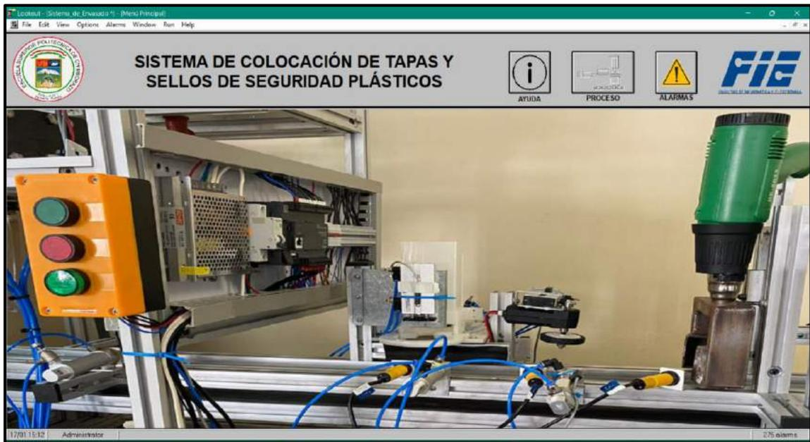
**Figura 40-2.** Panel principal de la aplicación HMI del sistema.
