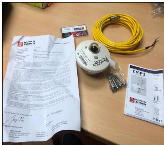
**Figura 11-3:** Sensor de radiación solar CMP3.
