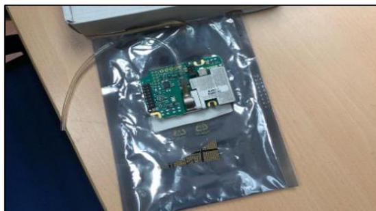
**Figura 10-3:** Sensor de presión barométrica R2850152.
