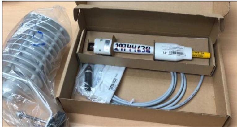
**Figura 15-3:** Sensor de temperatura con campana HMP155.
