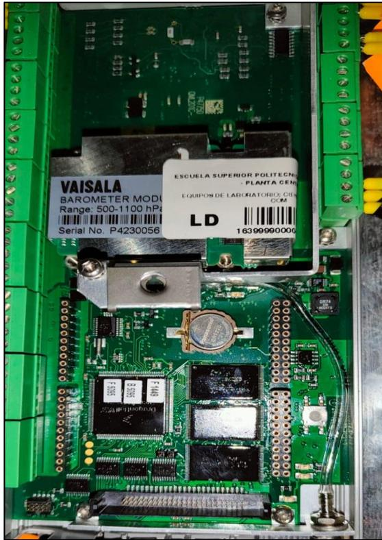
**Figura 1-4:** Módulo barométrico integrado en el *datalogger*.
