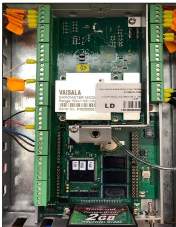
**Figura 2-3:** *Datalogger* con conexiones de los sensores.
