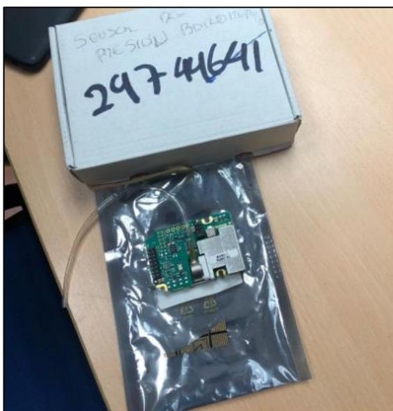
**Figura 13-3:** Sensor de presión barométrica R2850152.
