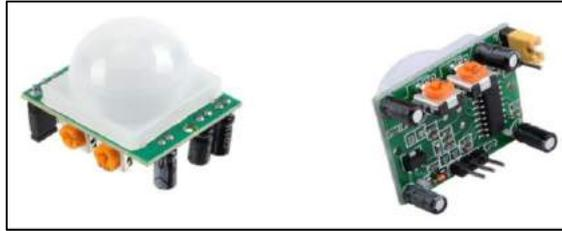
**Figura 3-2:** Sensor de movimiento PIR HC-SR501
