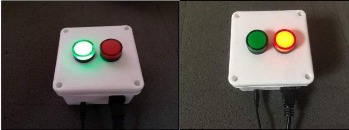
**Figura 17-3:** NA – luz verde encendida (izquierda) y luz roja encendida (derecha)
