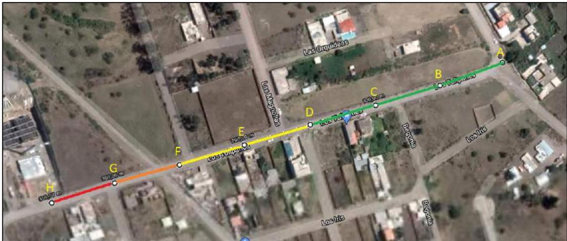
**Figura 6-3:** Comunicación wifi alcanzada con línea de vista
