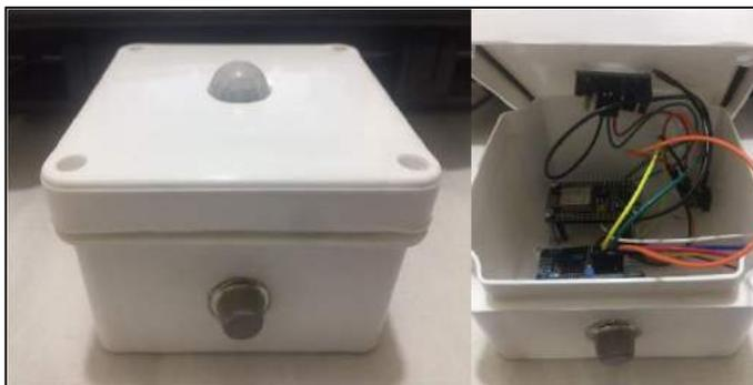
**Figura 1-3:** Nodo Sensor implementado
