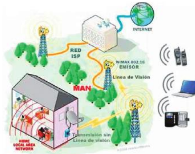
Ilustración 2-12: Estructura de la red 802.16
