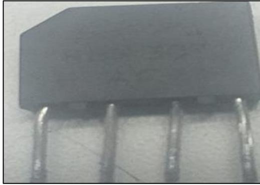
**Figura 8-2:** Puente de diodos DB104
