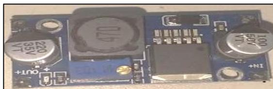
**Figura 15-2:** Convertidor de voltaje DC-DC XL6009
