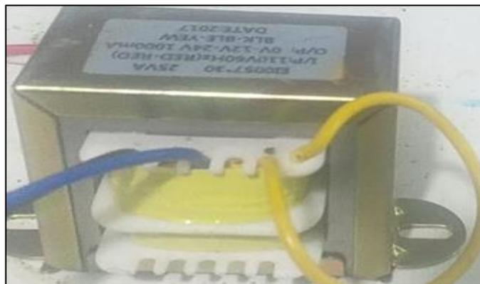
**Figura 7-2:** Transformador de 110 V a 24 V con tap central
