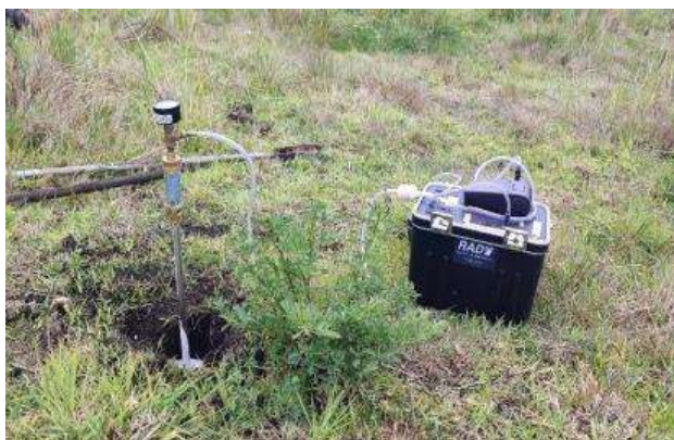
Ilustración 3-7: Medición de gas radón-222
