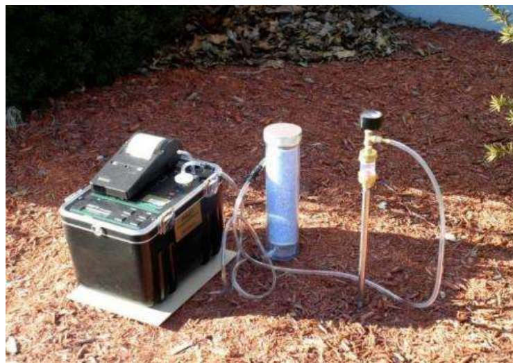
Ilustración 2-3: Sistema de detección de gas radón
