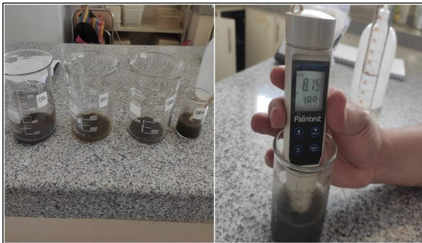
Ilustración 3-4: Determinación de pH y temperatura en laboratorio
