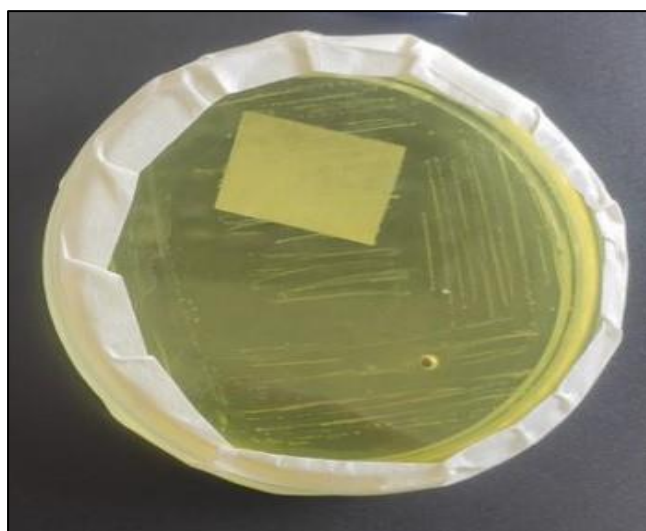
Ilustración 4-5: Pruebas de resistencia con Cr a concentración de 50000 ppm Muestra MC12_R1_C1
