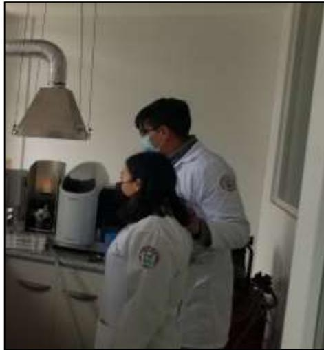
**Ilustración 24-2.** Determinación de metales en el espectrofotómetro de llama
