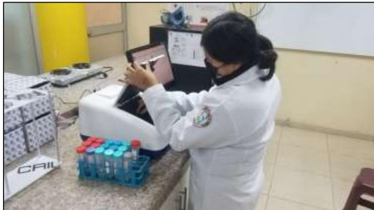
**Ilustración 22-2.** Medición de polifenoles en el espectrofotómetro UV-VIS
