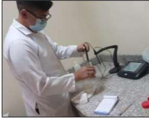
**Ilustración 15-2.** Medición de pH con el Multiparámetro
