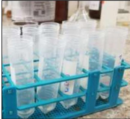
**Ilustración 21-2.** Estándares de calibración para el espectrofotómetro UV-VIS
