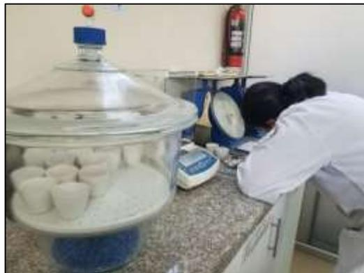
**Ilustración 18-2.** Pesaje de los crisoles con la materia calcinada
