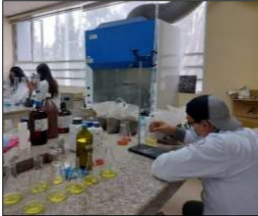
**Ilustración 26-2.** Proceso de Titulación de muestras para análisis de cloruros
