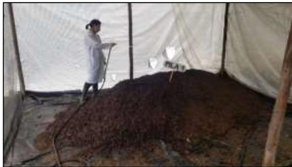
**Ilustración 7-2.** Riego de las pilas de compostaje
