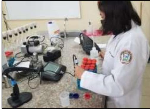
**Ilustración 16-2.** Medición de conductividad eléctrica con el multiparámetro
