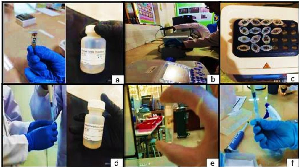
**Ilustración 3-2:** a) Adición de la solución de lisis nuclear b) Vortex por 3 s c) Incubación a 65°C d) Adición de la solución de precipitación de proteínas e) formación del pellet f) Transferencia del sobrenadante
