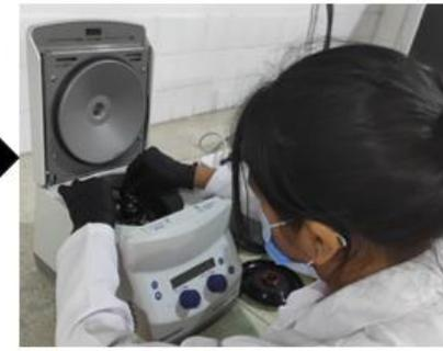
Centrifugación a 13000 rpm por 10 minutos
