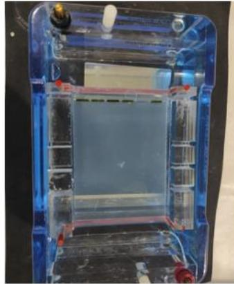
Una vez gelificada la agarosa se la coloca en la cuba de la electroforesis
