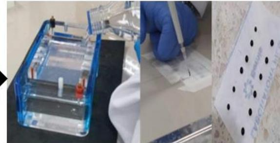
Se cubrió la superficie de agarosa con la solución TBe Buffer; mientras en el papel Parafilm se colocó los respectivos reactivos y muestras de PCR obtenidas.
