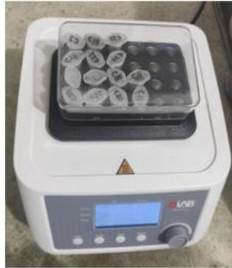
Se colocó en el termo bloque a 50 °C por 10 minutos con la tapa abierta
