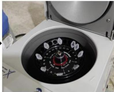
Centrifugación de muestras a 5000 rpm por 3 minutos
