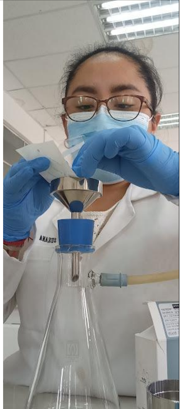
Fotografía 4. Colocación de la membrana millipore de 0.45 \mu\text{m} en el sistema de filtrado al vacío.
