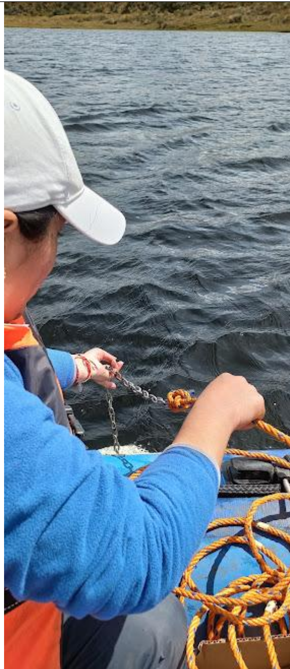
Fotografía 1. Medición de la transparencia del agua con el Disco Secchi.
