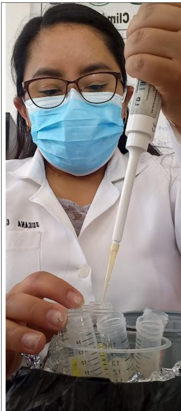
Fotografía 11. Colocación de 0,1 HCl a las muestras de agua (acidificación).
