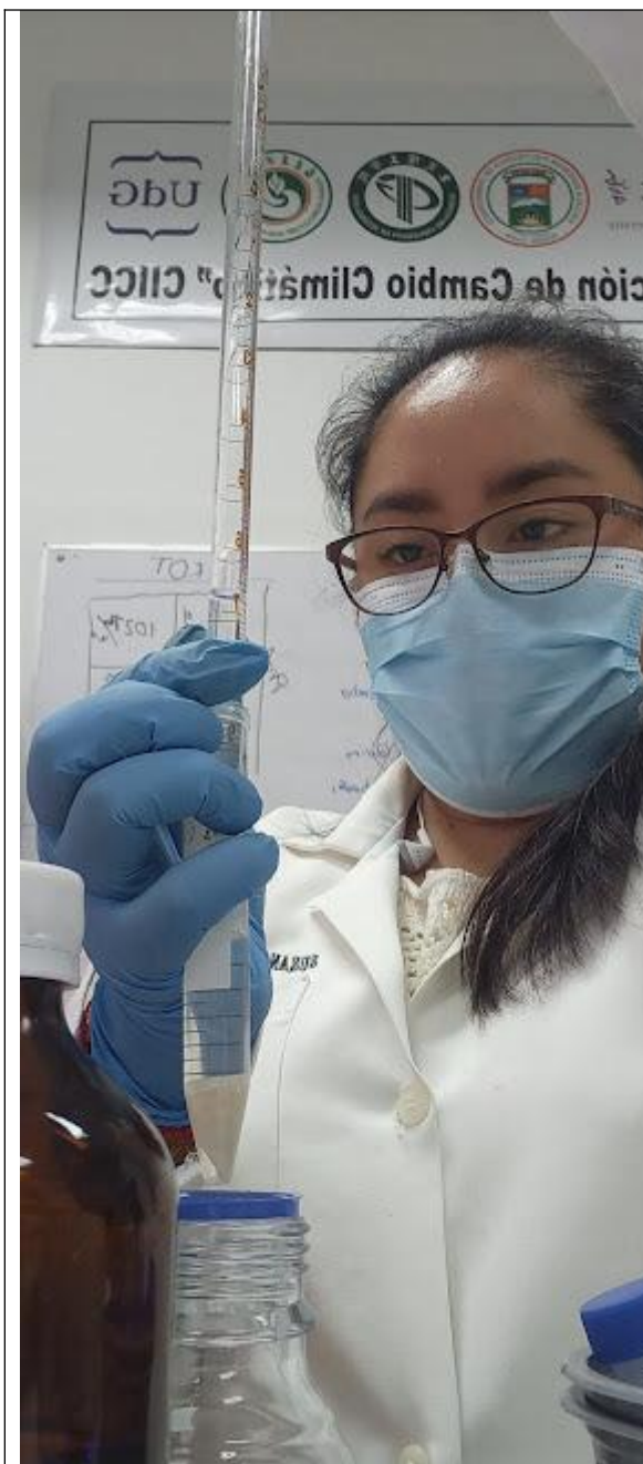
Fotografía 7. Colocación de acetona al 90% en el tubo de centrifuga plástico que contiene la membrana millipore de 0,45 \mu\text{m} .
