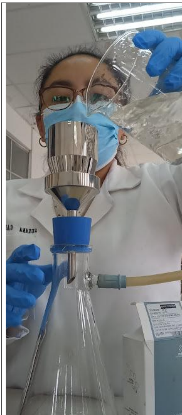
Fotografía 5. Filtración de las muestras en el sistema de filtrado al vacío.
