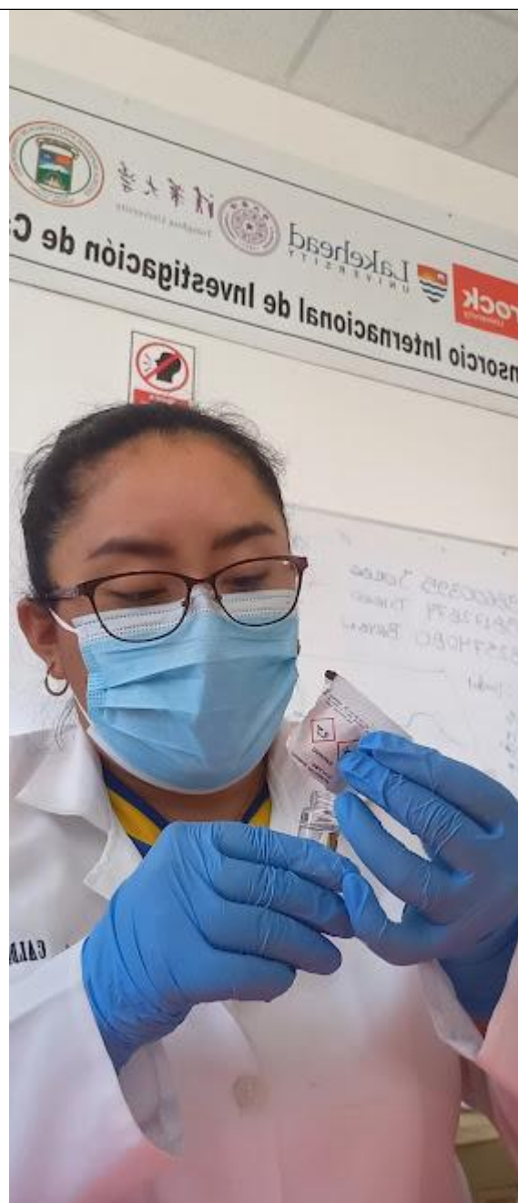
Fotografía 10. Colocación de los reactivos en las muestras para la medición de fosfatos.
