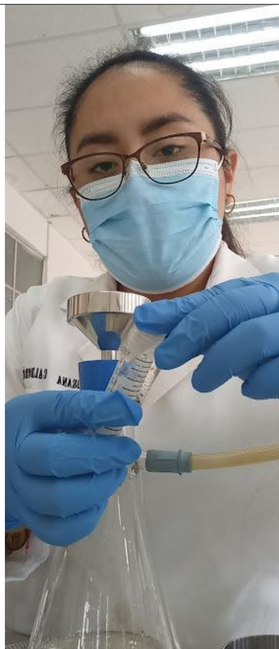
Fotografía 6. Colocación de la membrana millipore de 0.45 \mu\text{m} en el tubo de centrifuga plástico,
