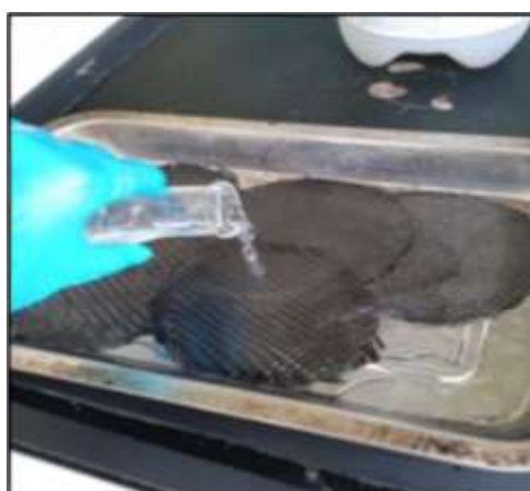
Ilustración 8-3: Ánodo sumergido en solución de peróxidisulfato de amonio y ácido sulfúrico
