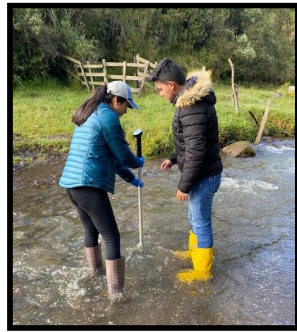
Medición de profundidad y velocidad del cauce
