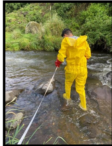
Medición del ancho del río
