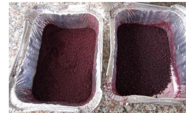
d) Cochinilla tamiza por malla ASTM 425 Y 140
