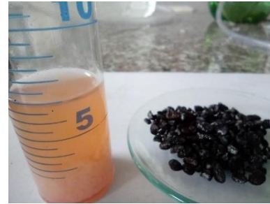
b) Dilución de acetona con cochinilla para la eliminación de cera
