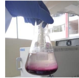
b) Precipitación del carmín mediante la adición de alumbre
