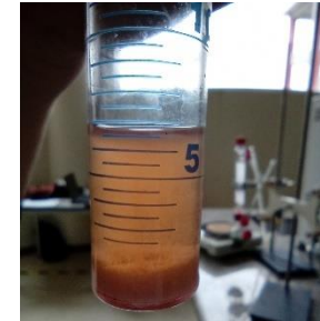
b) Dilución de acetona con cochinilla para la eliminación de cera
