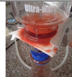
d) Filtración para eliminar residuos de cochinilla
