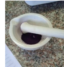
d) Secado y molienda del carmín
