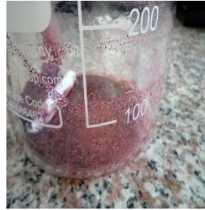
a) Extracción sólido-líquida de la cochinilla y cochinilla agotada
