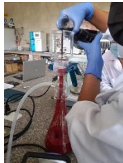
c) Separación del carmín mediante un proceso de filtrado
