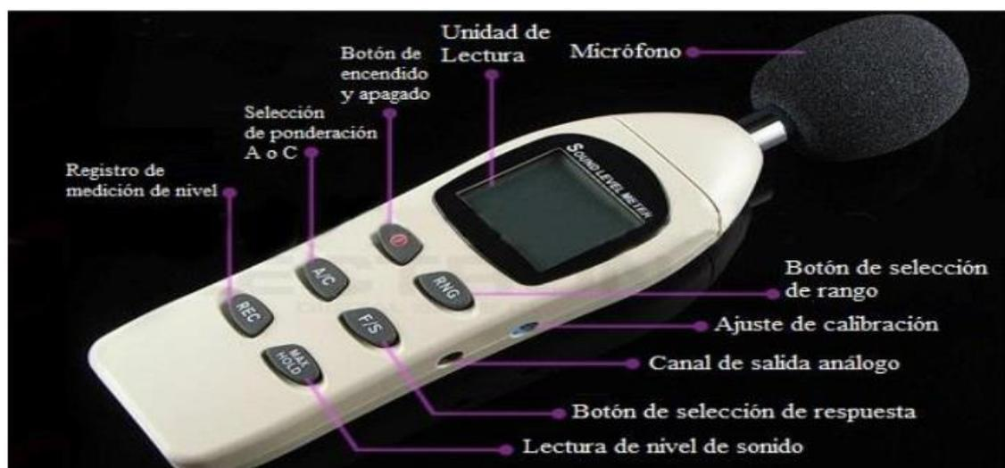
**Figura 2-2:** Partes de un Sonómetro
