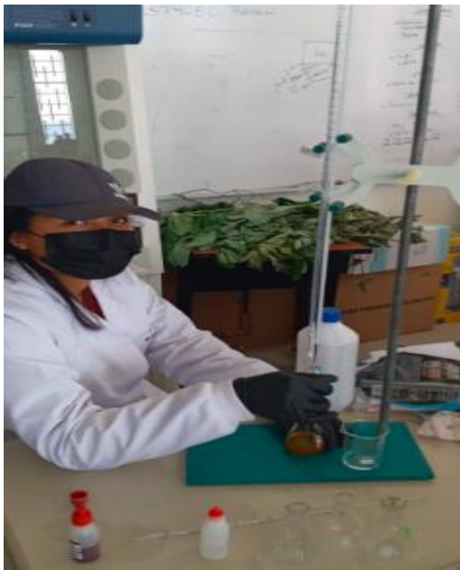
Titulación para la determinación de Bicarbonatos
