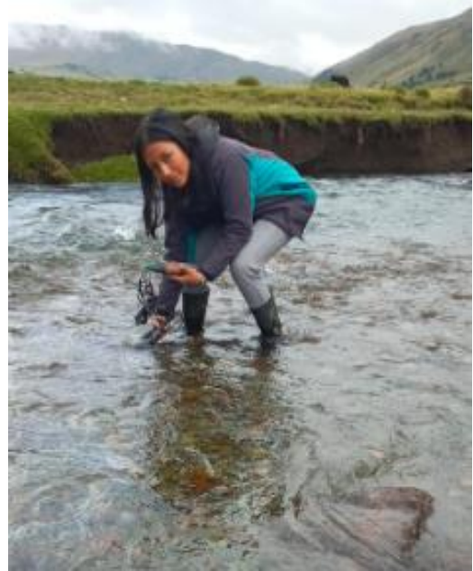
Uso de multiparámetros para la determinación de T, OD; CE y pH en agua superficial
