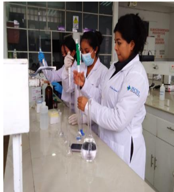
Preparación de estándares para la curva de calibración
