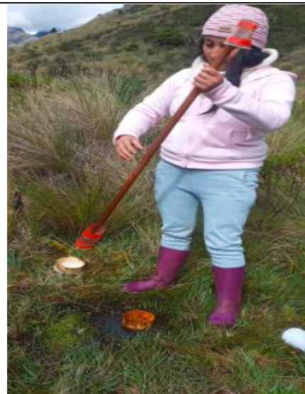
Método de recolección de muestra de agua intersticial
