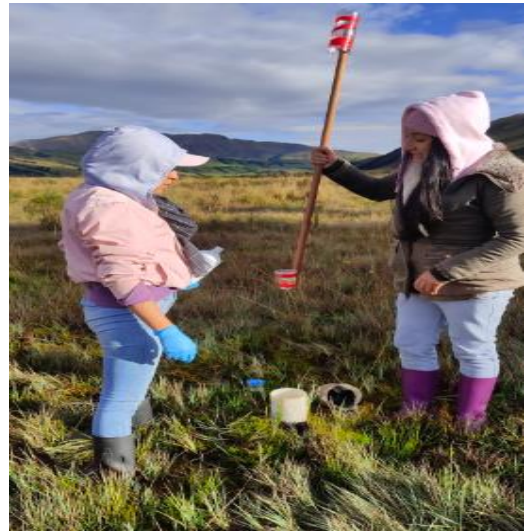
Método de recolección de muestra de agua intersticial
