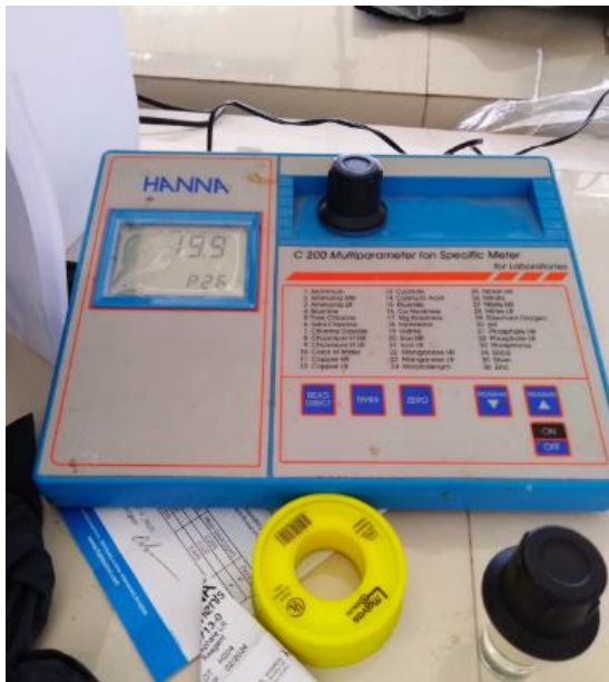
Equipo para la determinación de aniones con reactivos HANNA
