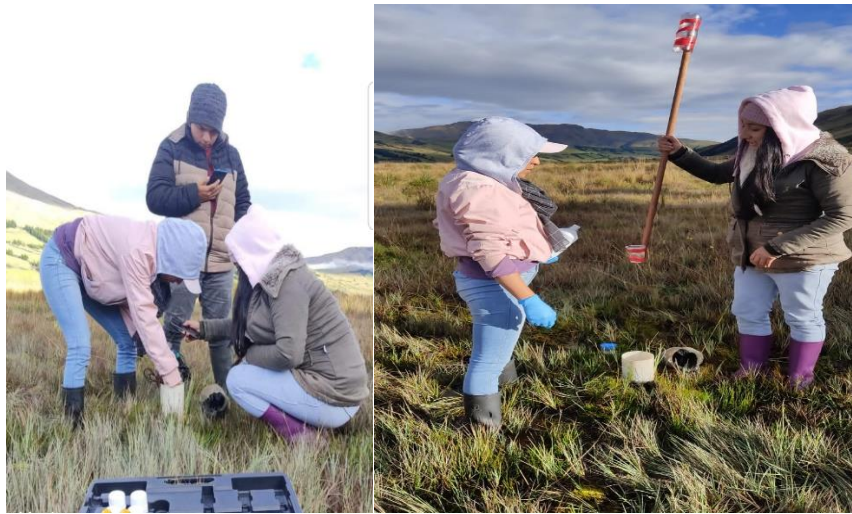
Ilustración 5-3: Muestreo Agua Intersticial
