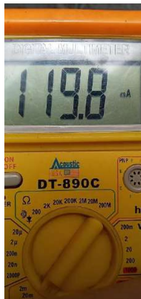
Figura 6-3: Medición de la corriente consumida Realizado por: Aragadvay Susana, 2021
