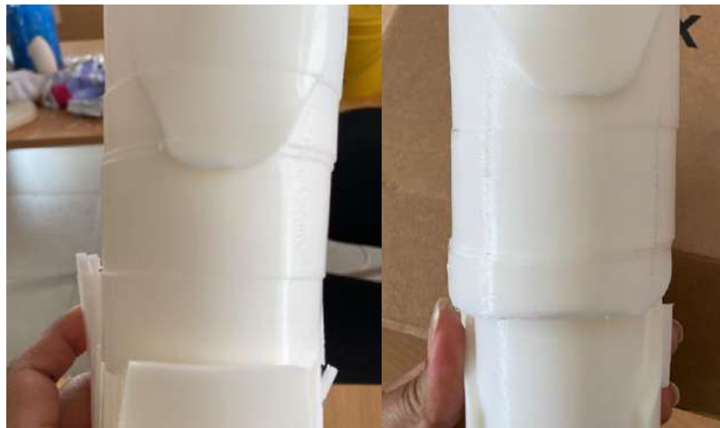
Ilustración 3-77: Piezas con mala impresión
