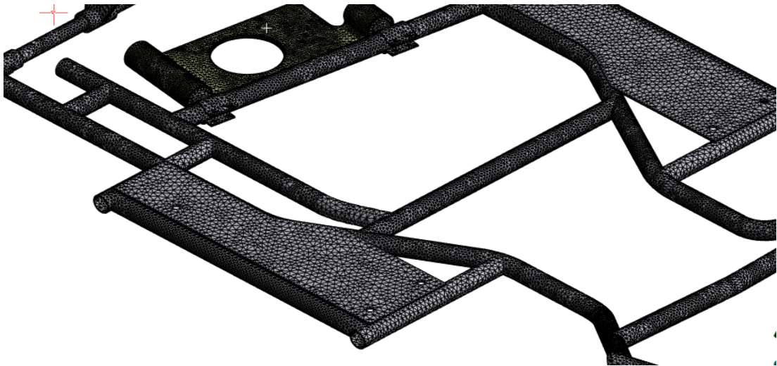
Ilustración 3-26: Mallado aplicado sobre los soportes del kit de baterías y chasis
