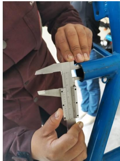
Ilustración 3-5: Toma de medidas del chasis homologado
