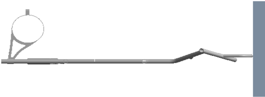
Ilustración 3-36. Impacto del chasis con una superficie perpendicular al plano de movimiento Realizado por: Mejía Kamila, 2023
