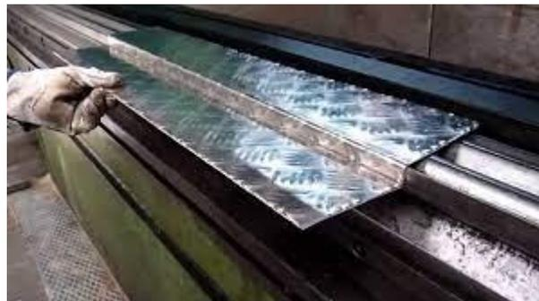
**Ilustración 3-26:** Doblado de lamina
