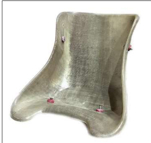
Ilustración 3-1: Asiento base para obtención del molde.
