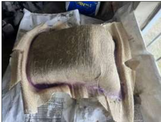
Ilustración 3-49: Aplicación de la fibra en el molde del asiento.
