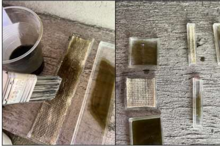
Ilustración 3-22: Aplicación de la fibra en moldes.
