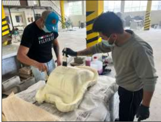
Ilustración 3-48: Aplicación de la resina en el molde del asiento.
