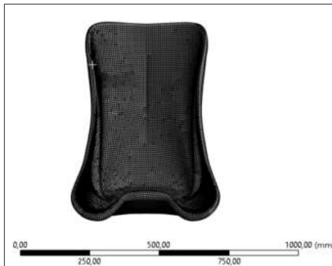
Ilustración 3-33: Mallado del asiento Go-Kart en Ansys.
