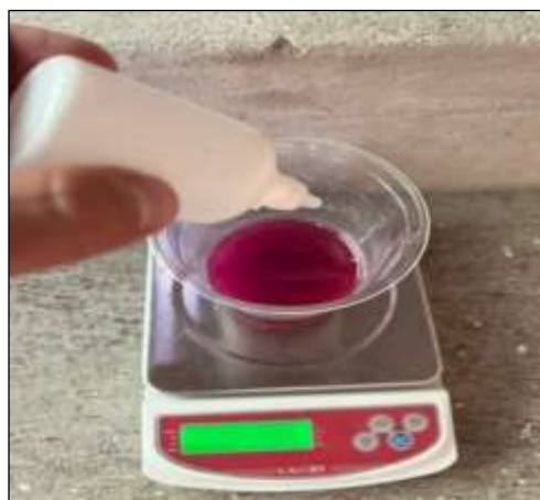
Ilustración 3-20: Aplicación del metiletilcetona.
