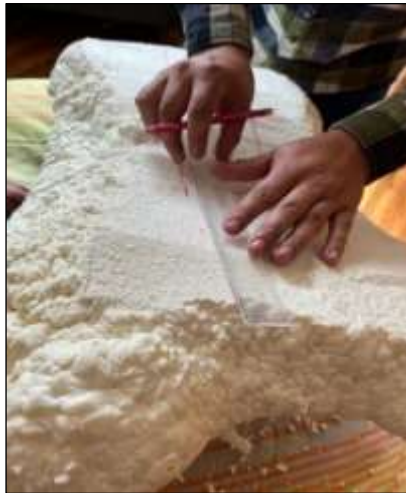
Ilustración 3-43: Extracción del molde del asiento.
