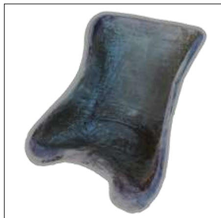
Ilustración 4-23: Deformación del asiento del Go-Kart.
