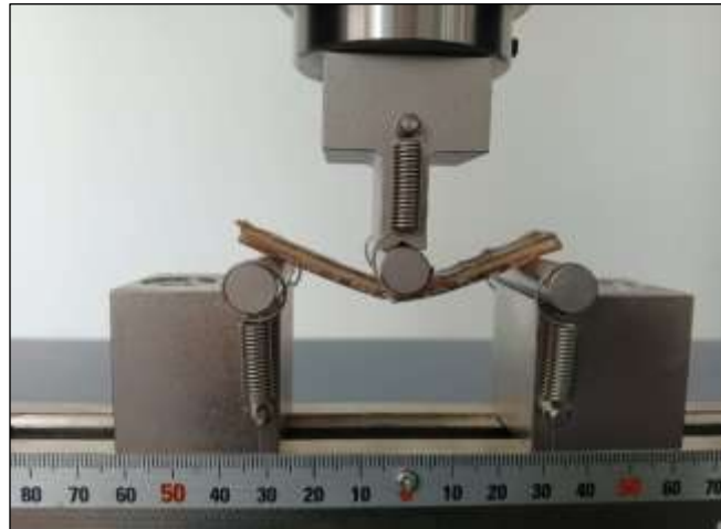
Ilustración 3-26: Ensayo de flexión en probeta 1.
