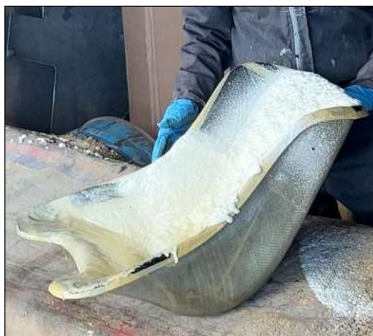
Ilustración 3-40: Aplicación de espuma de poliuretano en asiento base.
