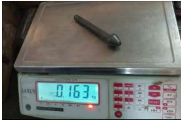
Ilustración 3-27: Cuerpo usado en ensayo de impacto.
