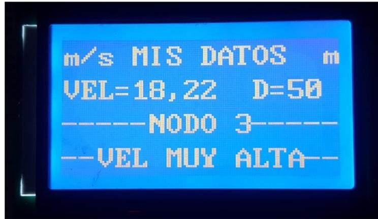
**Figura 34-2:** Mensaje que se despliega el nodo móvil en principal cuando el nodo móvil en secundaria excede el límite de velocidad
