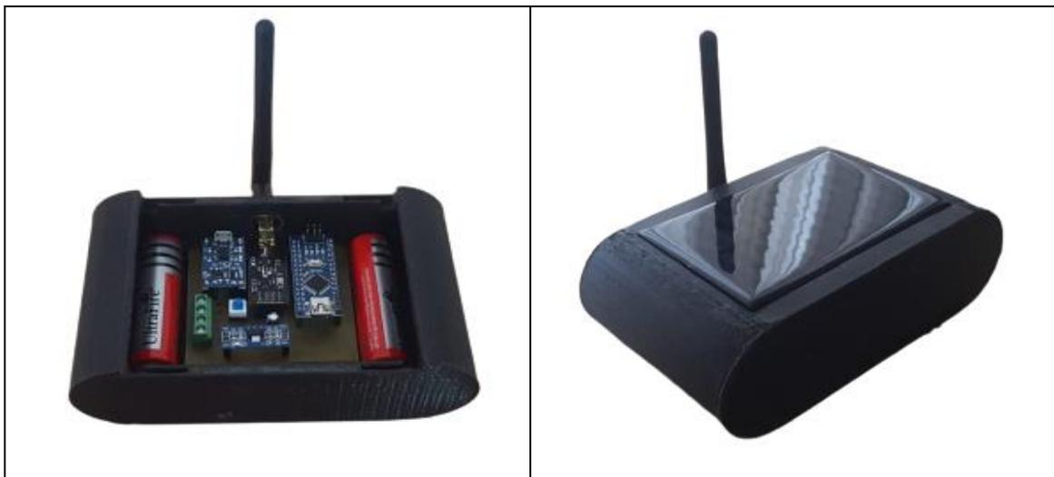
**Figura 22-2:** Carcasa fabricada para el nodo fijo
