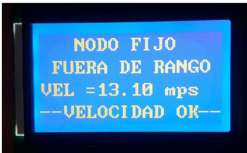
**Figura 32-2:** Mensaje que se despliega en el LCD cuando el nodo móvil no está en el rango del nodo fijo y no circula a exceso de velocidad
