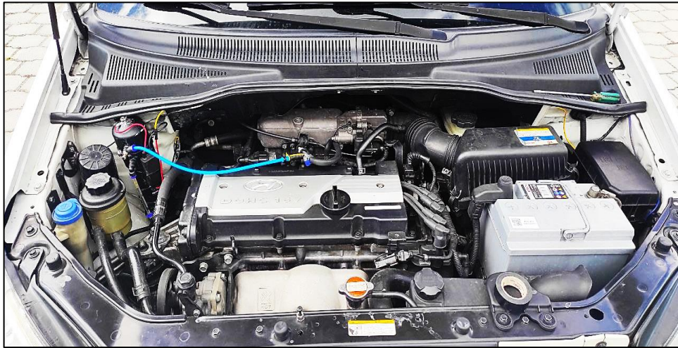
Ilustración 3-22: Instalación completa de la celda de hidrógeno.
