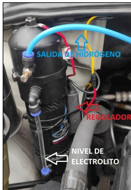
Ilustración 3-19: Celda de hidrógeno acoplada en la carrocería.
