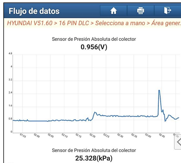
Ilustración 4-8: Lectura del sensor MAP con el escáner.
