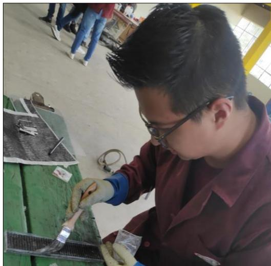
**Ilustración 3-20:** Proceso de laminación de las probetas.
