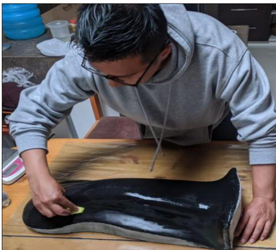
**Ilustración 3-26:** Aplicación de desmoldante polivinílico sobre el molde.
