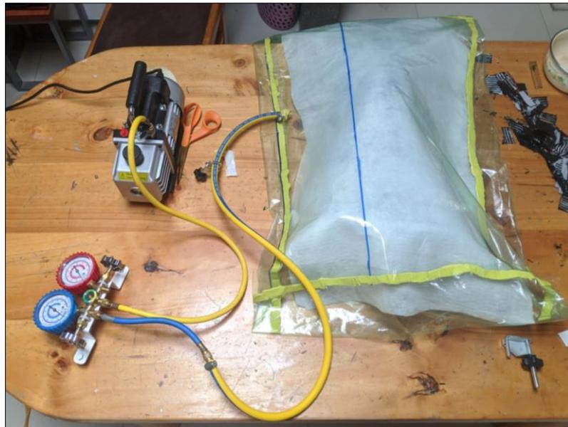
**Ilustración 3-35:** Bolsa de vacío sellada y conectada a la bomba de vacío.
