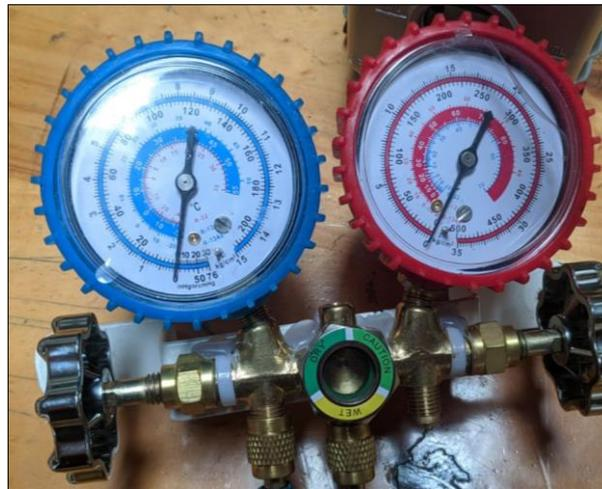
**Ilustración 3-36:** Presión inicial al interior de la bolsa antes de encender la bomba de vacío.
