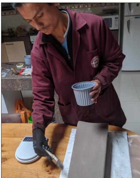
**Ilustración 3-30:** Aplicación de una capa de resina epoxi para laminación sobre el molde.
