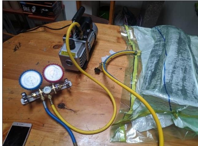
**Ilustración 3-38:** Vacío generado dentro de la bolsa.
