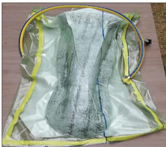
**Ilustración 3-39:** Curado de la pieza manteniendo la presión generada por el vacío.
