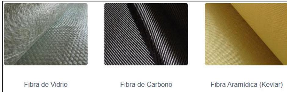
**Ilustración 2-16:** Principales fibras de refuerzo.
