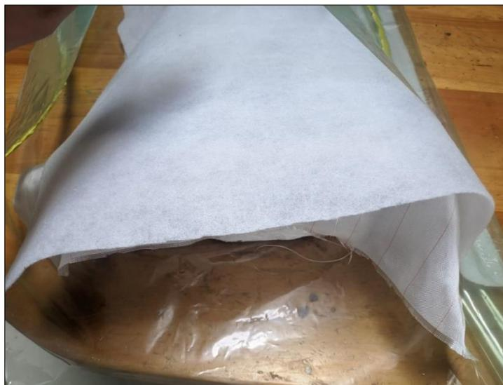
**Ilustración 3-33:** Aplicación de la manta absorbente sobre el molde.
