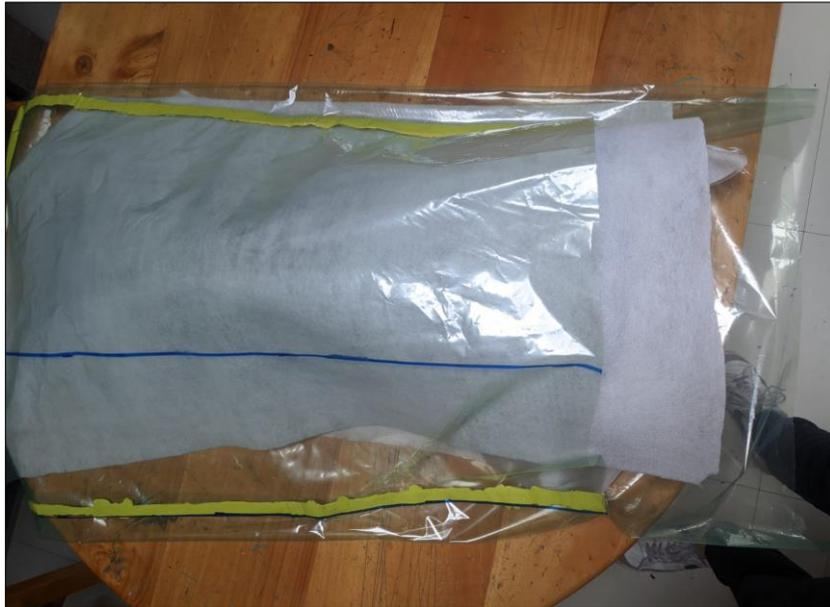
**Ilustración 3-34:** Introducción del conjunto de laminado, *film* separador y *film* absorbente en la bolsa de vacío.
