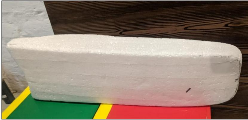
**Ilustración 3-24:** Molde resultado del proceso de corte y pulido de la espuma de poliestireno.
