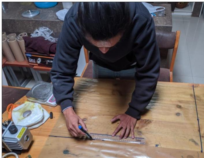
**Ilustración 3-28:** Demarcado del *film* de nylon para la bolsa de vacío previo a su corte.
