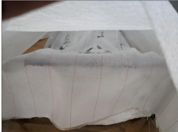
**Ilustración 3-32:** Aplicación del tejido pelable (*peel plie*) sobre el molde.
