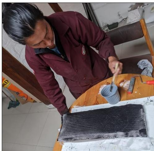
**Ilustración 3-31:** Aplicación de una capa de fibra de carbono sobre el molde.
