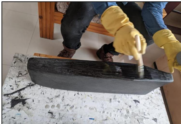
**Ilustración 3-40:** Aplicación de Coating Epoxy a la pieza final
