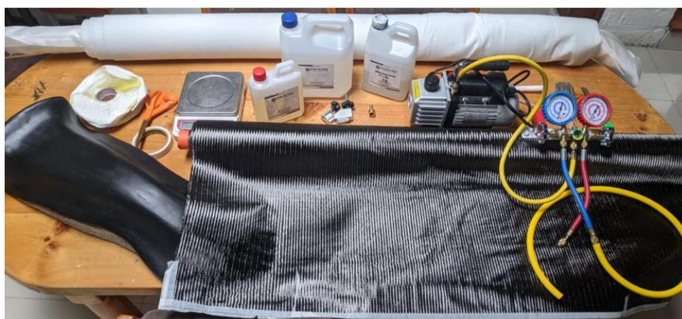
**Ilustración 3-27:** Preparación de los materiales previos a la laminación.
