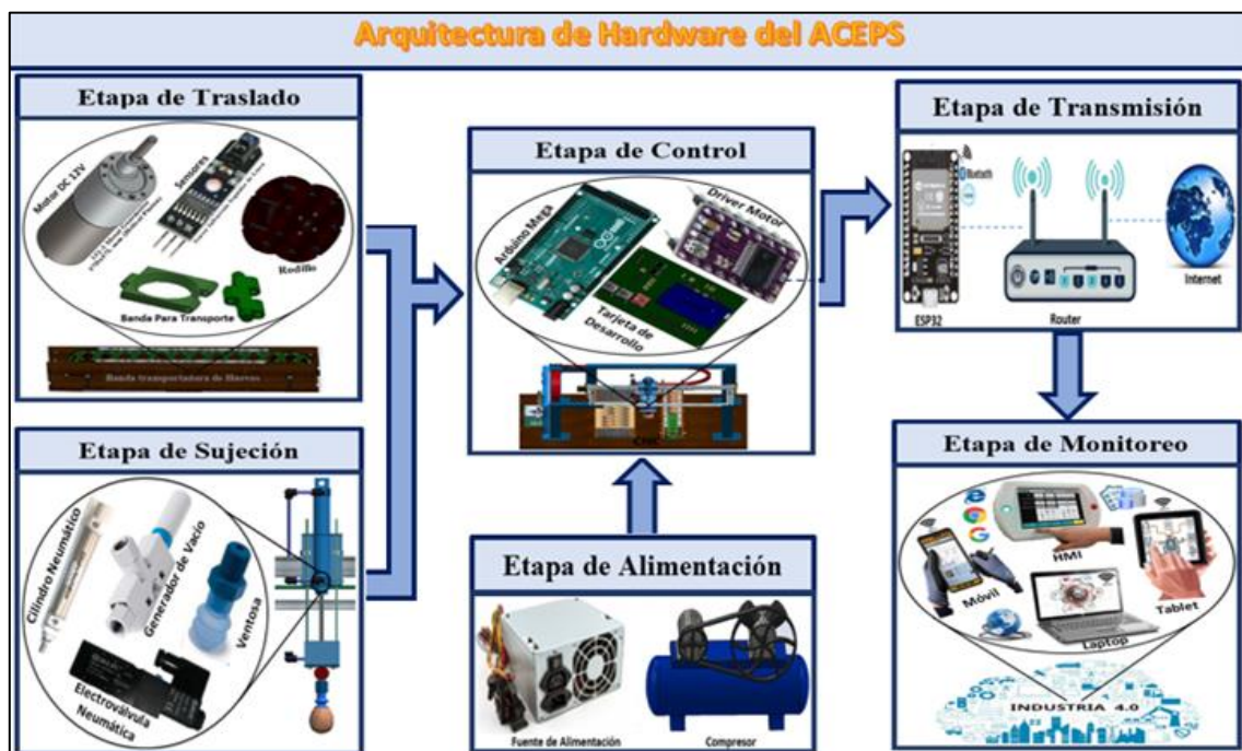
Figura 1-2: Arquitectura de Hardware del ACEPS
