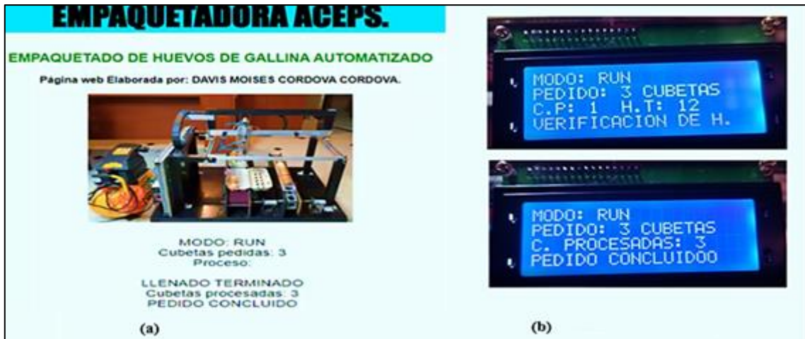
Figura 4-3: Prueba comunicación del ACEPS a) Página Web b) Visualización de Display
