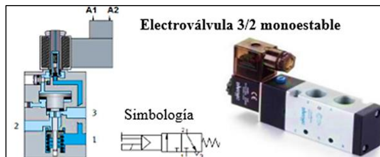
Figura 23-1: Electroválvula de 3/2 vías monoestable
