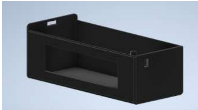
Figura 26-2. Diseño estructural de la base
