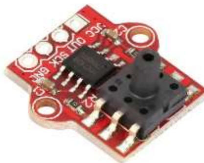
Figura 11-2. Sensor de presión
