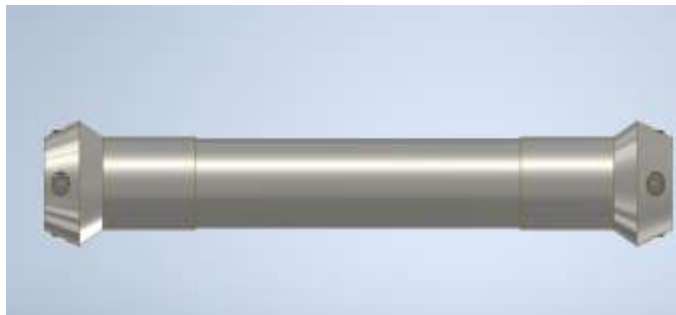
Figura 16-2. Tubo y adaptadores hembra, diseñado en el Software Inventor
