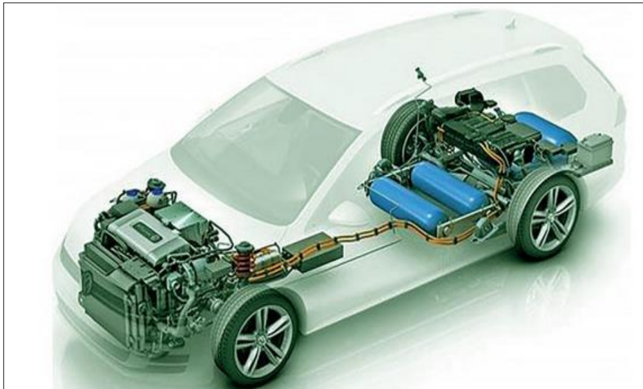
Ilustración 2-7: Vehículo eléctrico con pilas de hidrogeno.
