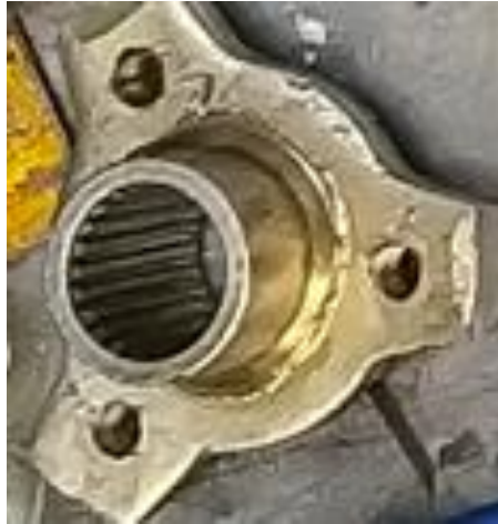
Ilustración 3-37: Cubo de rueda mecanizado
