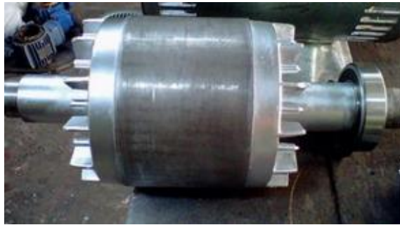
Ilustración 2-17: Rotor jaula de ardilla.
