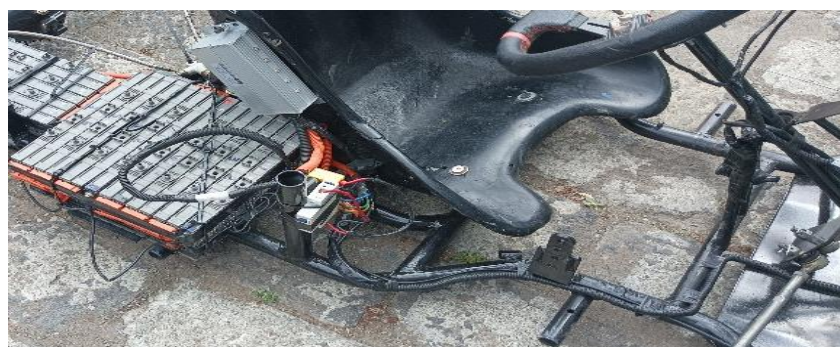
Ilustración 3-45: Ubicación del controlador y elementos de seguridad.
