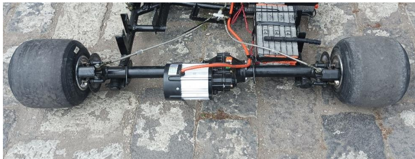
Ilustración 3-42: Montaje de la tracción eléctrica
