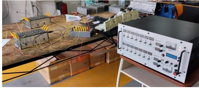
Ilustración 3-21: Proceso de precarga de la batería
