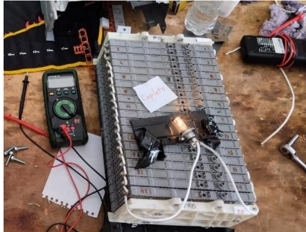
Ilustración 3-18: Descarga profunda de las baterías
