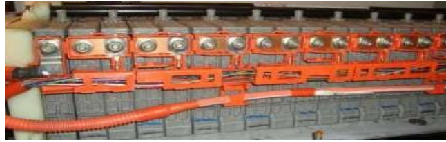
Ilustración 3-16: Extracción de sensores de temperatura y colector de gases
