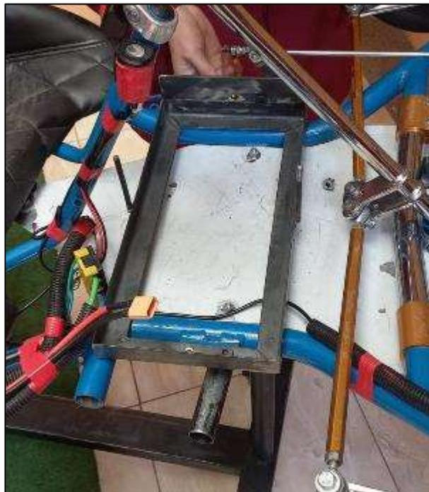
**Ilustración 3-12:** Base de la batería
