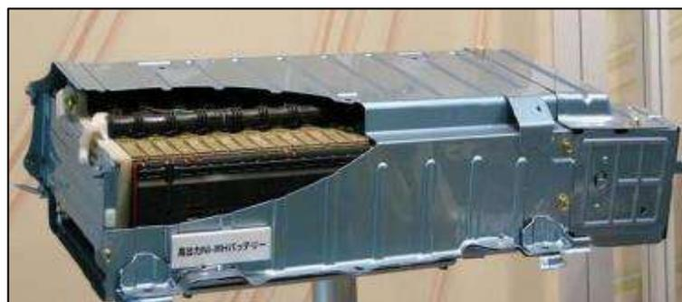
**Ilustración 2-11:** Batería níquel metal hidruro
