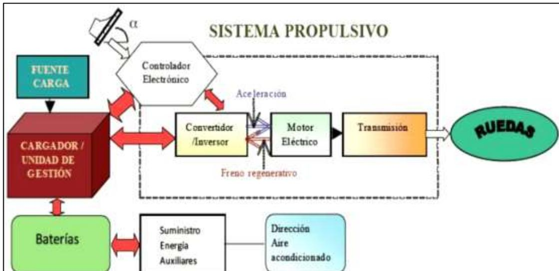
**Ilustración 2-5:** Esquema del sistema de propulsión eléctrica
