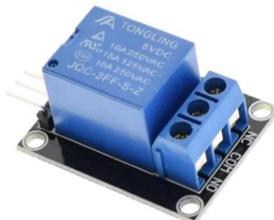
**Figura 8-2:** Relé de 5VDC JQC-3FF-S-Z.
