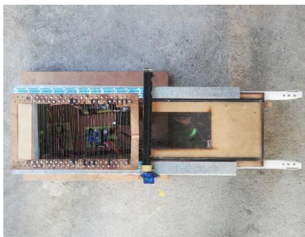
**Figura 1-3:** Prototipo electrónico para extracción de apitoxina.
