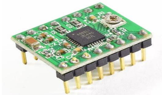
**Figura 5-2:** Driver A4988 para motor a pasos.
