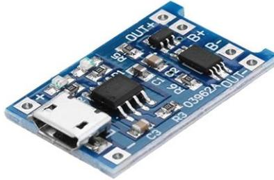
**Figura 18-2:** Módulo de carga TP4056.
