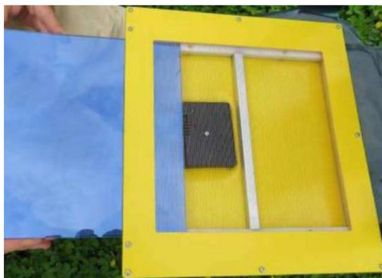
**Figura 1-4:** Dispositivo recolector de apitoxina marca KETLITEN.
