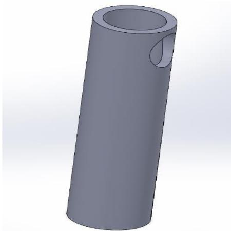
**Figura 1:** Diseño del acoplamiento para el piñón del motor a pasos.
