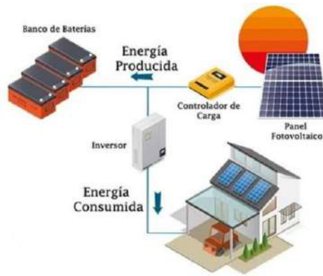
Figura 3-1: Microred aislada. Fuente: (SRL, 2020)
