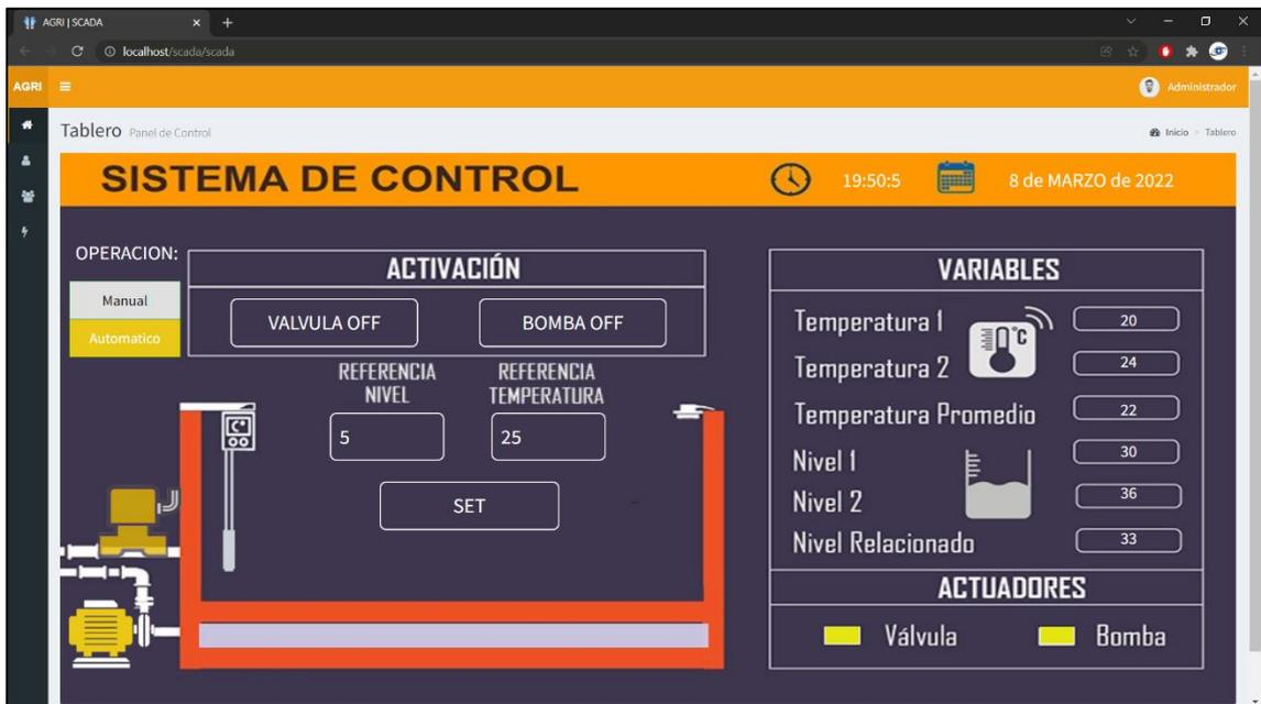
**Figura 33-3:** Pantalla principal de programación del Sistema Automatizado de nivel y de temperatura del nitrilo.
