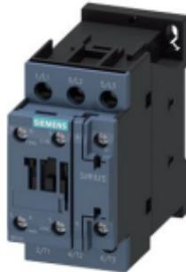
Contactora de potencia, AC-3 12 A, 5,5 kW/400 V 1 NA + 1 NC, 220 V AC 50/60 Hz, 3 polos tamaño S0, conexión por tornillo
