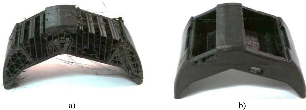
Ilustración 14-3 a) Pieza impresa en 3D antes de pulir, b) Case SADMI impreso en ABS, después del proceso de pulido
