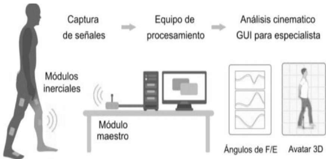
Ilustración 9-2: Funcionamiento general de un sistema basado en sensores inerciales
