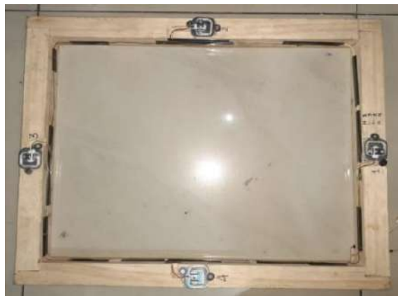
Ilustración 23-3: Celdas Sen-10245 colocadas sobre la base de la colmena Langstroth
