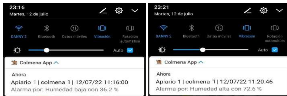
Ilustración 13-4: Generación de notificaciones al detectarse un rango “alto” y “bajo” de humedad relativa.
