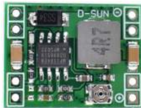
Ilustración 16-3: Regulador MP1584EN Step-down.
