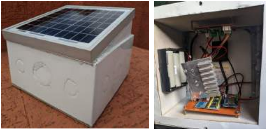
Ilustración 1-4: Instrumento recolector de datos de irradiancia solar desarrollado.
