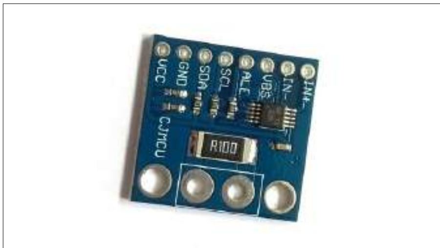
Ilustración 5-3: Medidor de corriente y potencia bidireccional, INA226.
