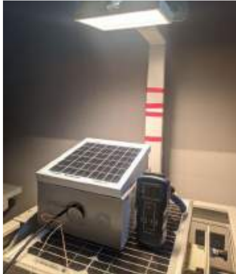
Ilustración 1-3: Pruebas de laboratorio con el medidor de potencia solar SM206-SOLAR.
