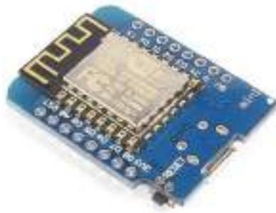
Ilustración 12-3: Wemos D1 Mini ESP8266 WIFI.
