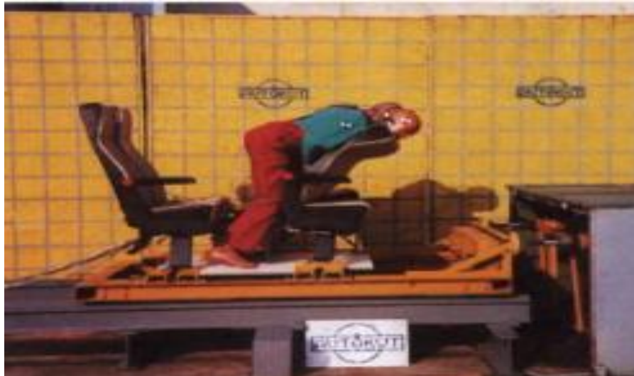
Ilustración 2-12: Estudio de impacto con la máquina de pruebas dinámicas.
