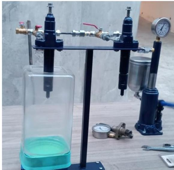
**Ilustración 4- 2:** Prueba forma de chorro
