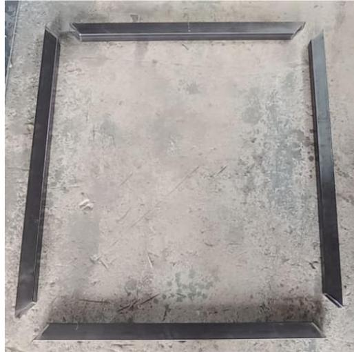
**Ilustración 3- 11:** Cubierta del soporte base recortada
