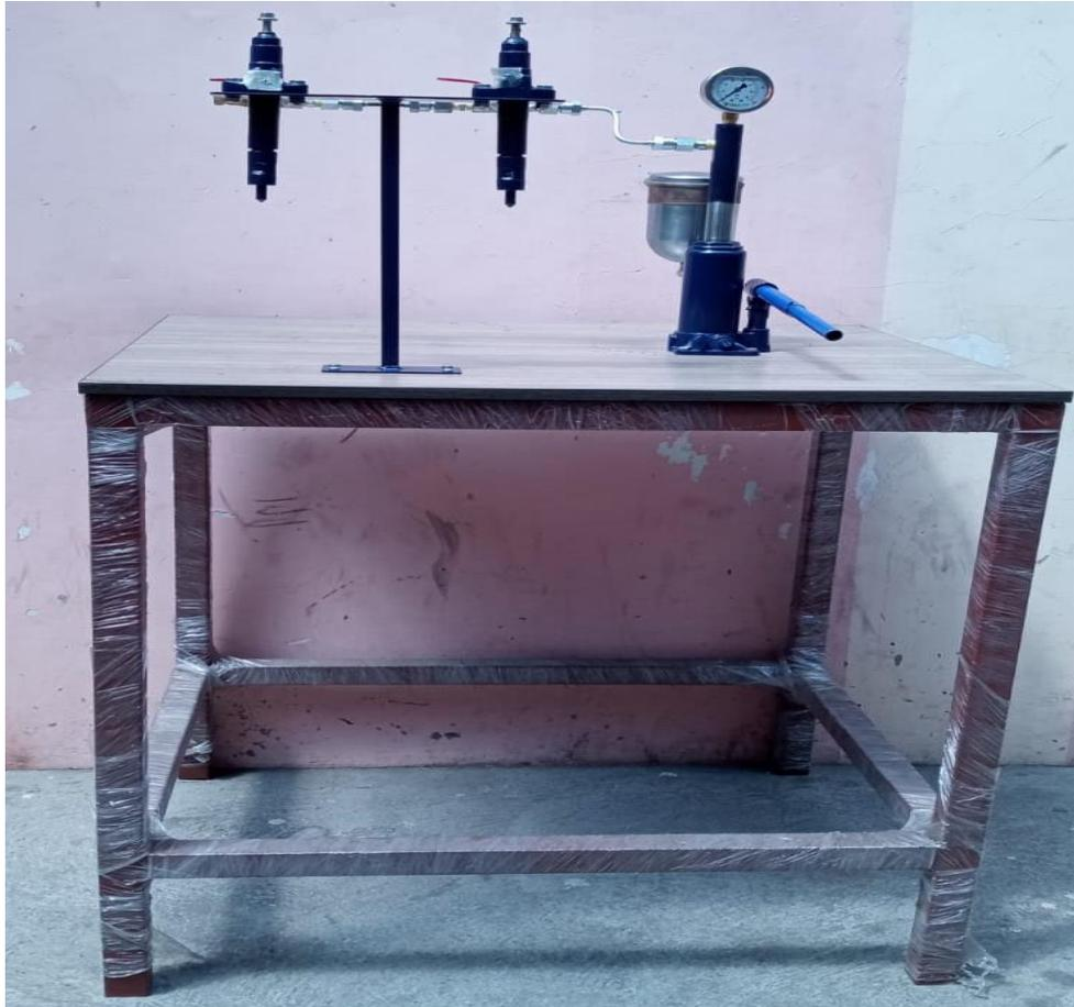
**Ilustración 4- 4:** Comprobador de Inyectores Mecánicas terminado
