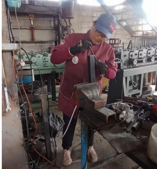
**Ilustración 3- 12:** Limado de imperfecciones del tubo
