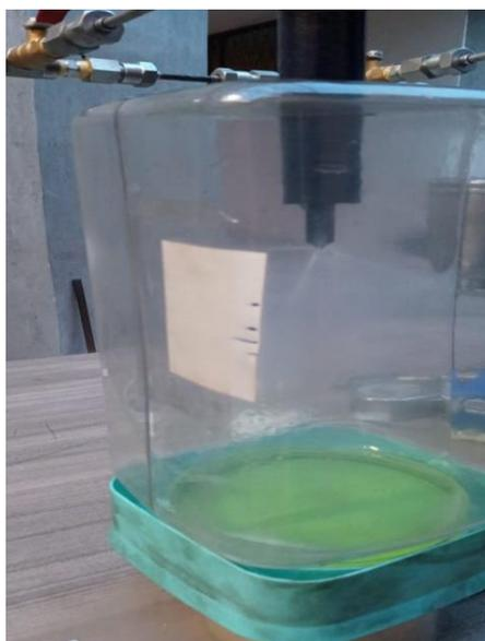
**Ilustración 3- 38:** Punto máximo y mínimo del chorro de pulverización
