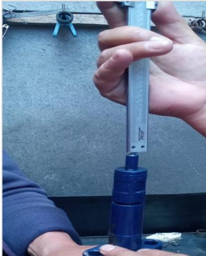
**Ilustración 3- 35:** Medida de los orificios del Inyector
