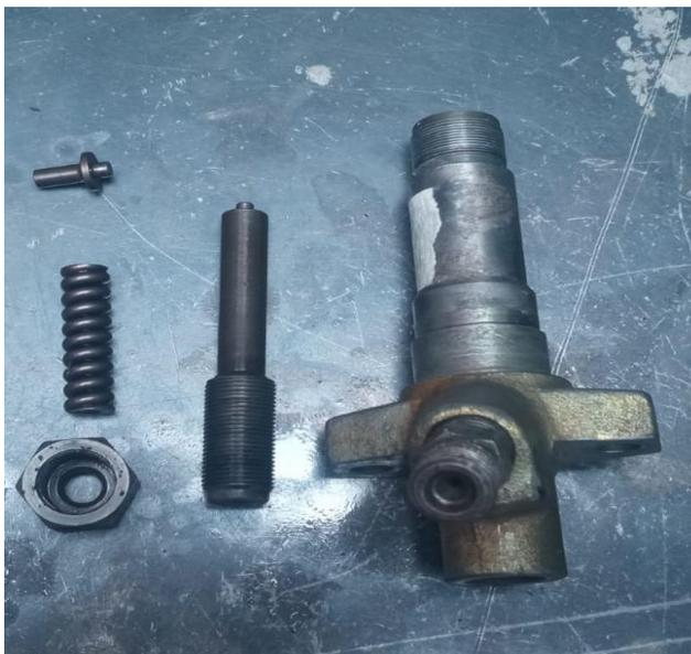
**Ilustración 3- 25:** Inyector Mecánico
