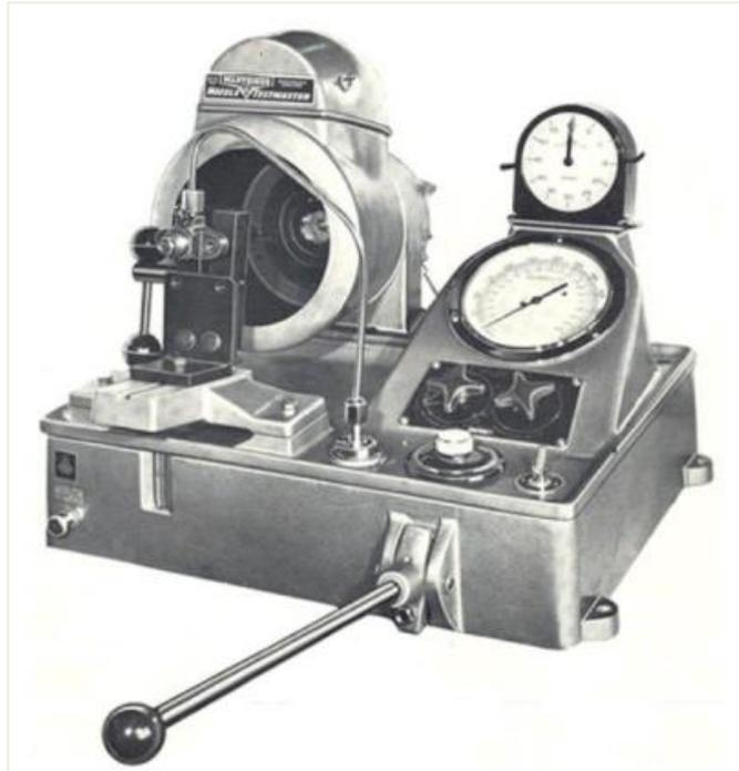
**Ilustración 2- 15:** Comprobador Hartridge HH601 diésel mecánico
