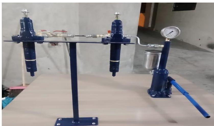
**Ilustración 3- 33:** Comprobador de Inyectores
