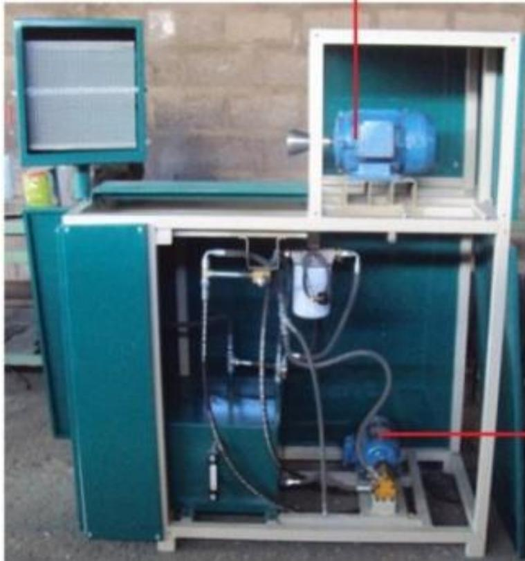
**Ilustración 2- 17:** Diseño Y Construcción De Un Comprobador De Grupos Electr6genos De Motor Serie 3500 Caterpillar
