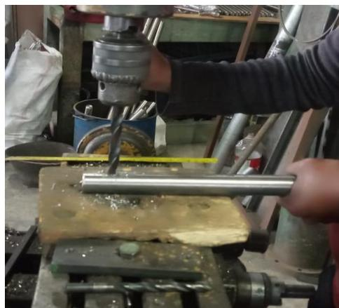
**Ilustración 3- 29:** Perforación del tubo
