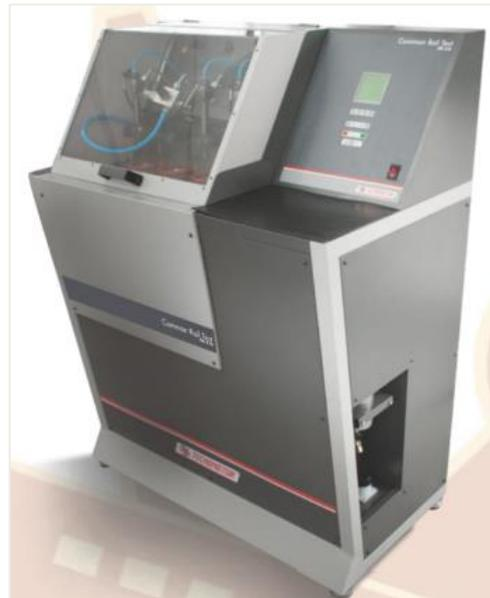
**Ilustración 2- 14:** Banco para pruebas de inyectores diésel TM 510
