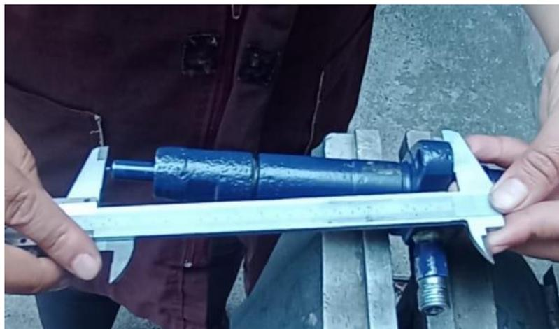
**Ilustración 3- 36:** Medidas de referencia del Inyector
