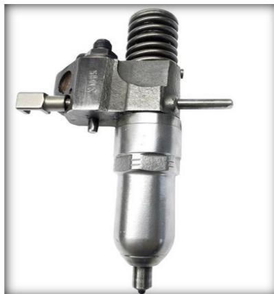
**Ilustración 2- 12:** Inyectores mecánicos
