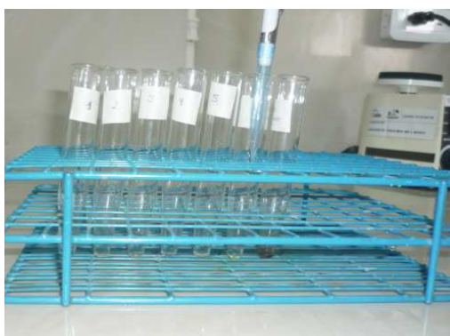
Reconstitución de los residuos con metanol HPLC
