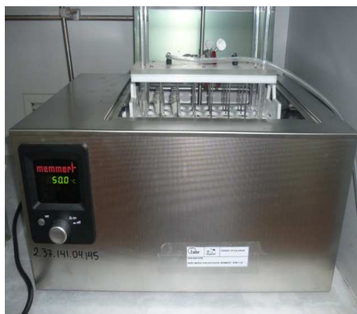
Evaporación del eluido a sequedad con gas nitrógeno 99,9% de pureza
