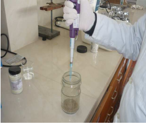
Fortificación de la muestra con una solución madre de Ocratoxina A
