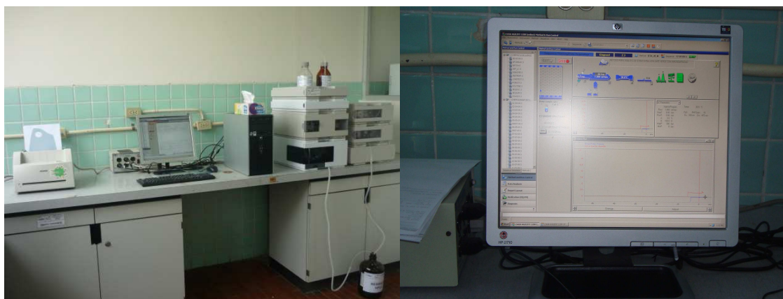
Lectura en el Equipo HPLC Agilent 1200
