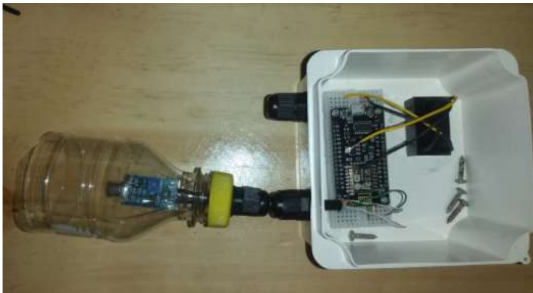
Ilustración 3-23: Diseño de la caja con el sensor fuera de ella.
