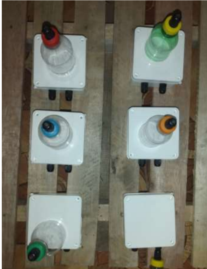
Ilustración 3-20: Cajas impermeable IP5 y el medio de protección para el sensor.
