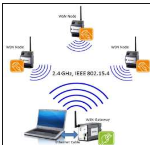
Ilustración 2-7: Elementos de una red WSN.
