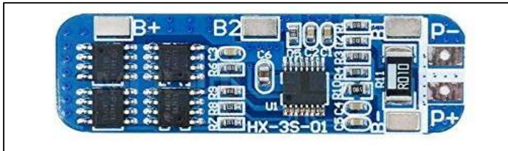
Ilustración 3-17: Cargador de batería de litio (BMS).
